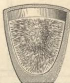
Fig. 24. Nadelförmiger Schwefel.
