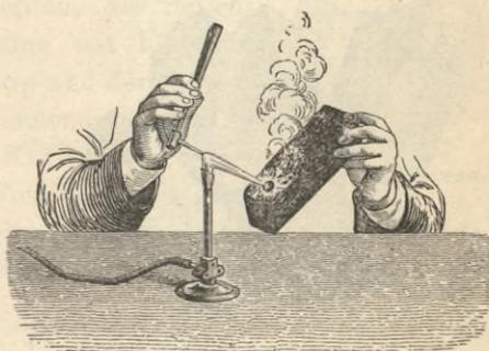
Fig. 32. Verbrennen von Arsen.
