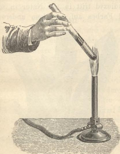
Fig. 31. Arsenspiegel.
