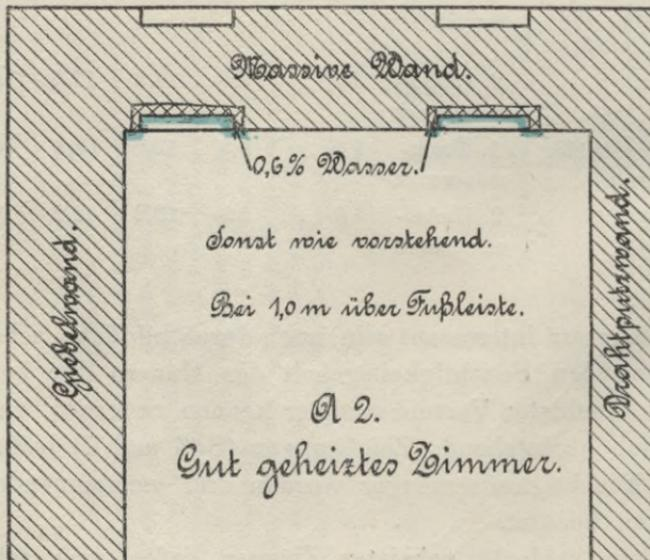
Der Isolierung der Mauerflächen wird in reell und modern ausgeführten Berliner Wohnhäusern durch Aufstellen von Isolierwänden an den Giebel- und Brüstungswänden entsprochen; es wird
