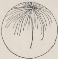
Abb. 16. Sprünge in einer von innen gesprengten Glaskugel.
