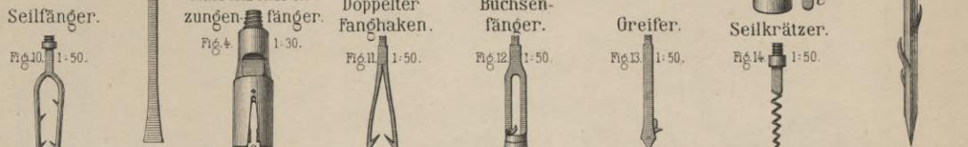
Seilfänger. Rutschscheren-zungen-fänger. Doppelter Fanghaken. Einfaches Seilmesser. Verstellbares Seilmesser. Geschlossene Klappenseilmesser. Zweitheiliger Seilfanghaken. Dreitheiliger Seilfanghaken. Klappen-seilfänger.
