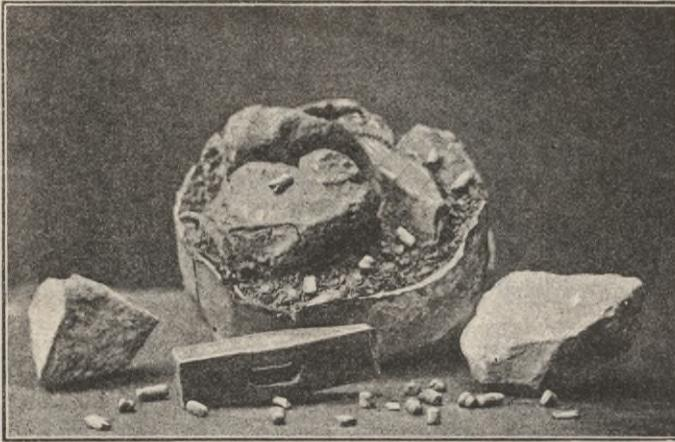
Fig. 14. Positiver Abdruck der Sohle eines 250 m tiefen Bohrlochs, sowie die zu Tag geförderten Gegenstände. M. 1:5.
