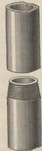
Fig. 12. Futterröhren mit stark konischen Gewinden.
