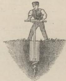
Fig. 4. Der einfache Erdbohrer.
