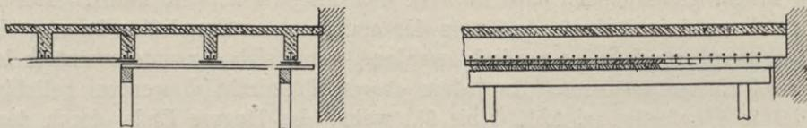
Abb. 47. Querschnitt und Längsschnitt der Putzdecke von Leschinsky.
