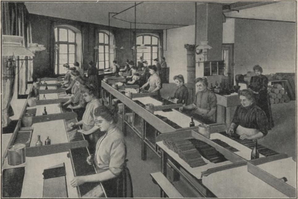
Abb. 750. Sandpolieren der Bleistifte in der Lyra-Bleistiftfabrik, Nürnberg.
