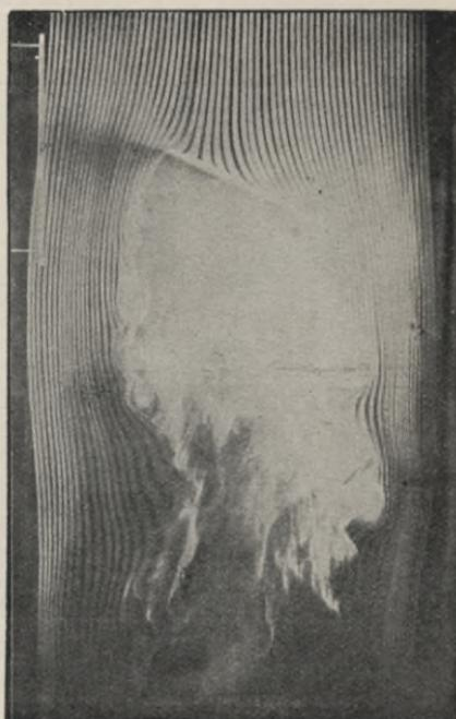
Abb. 841. Ablenkung des geradlinigen Luftstromes durch ein schräg entgegengehaltenes Blätterblatt.
