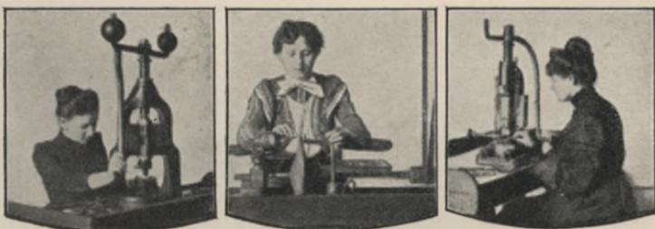
Abb. 743. Das Biegen, Schleifen und Spalten der Federplättchen.
