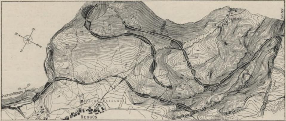
Abb. 32. Lageplan der Doppelschleife der Albulabahn bei Bergün.
