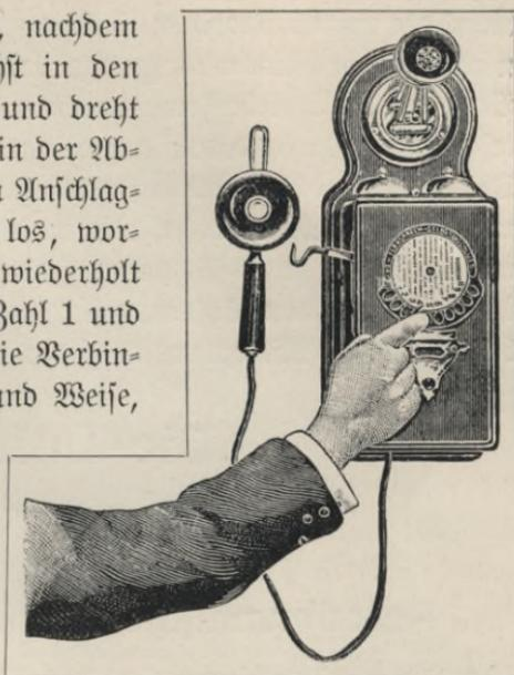
Abb. 267. Linienwähler beim Herstellen der Verbindung.
