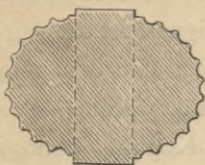
GRUNDRISS EINES PFEILERS MIT HALBSÄULEN.
