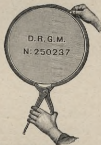
Fig. 203 a. Einsetzen des Kolbenringes von Maak.
