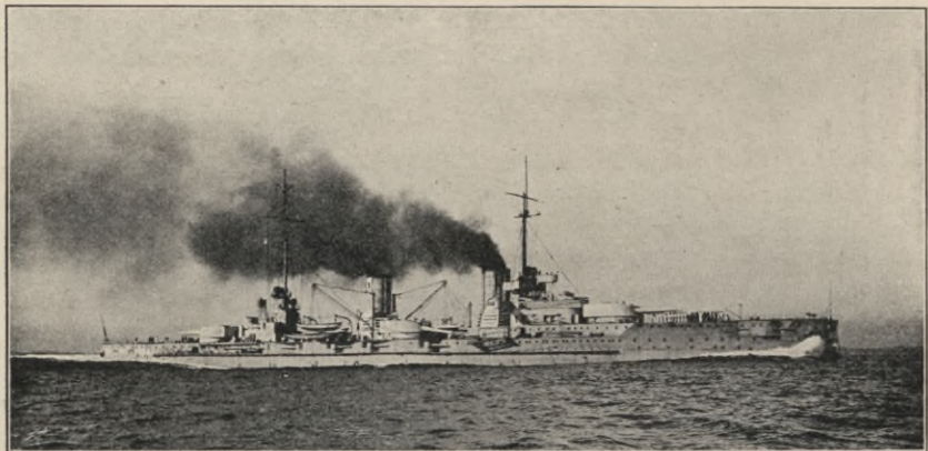
Fig. 95. Panzerkreuzer „von der Tann“. 1909. 19 000 t. 28 Kn.
