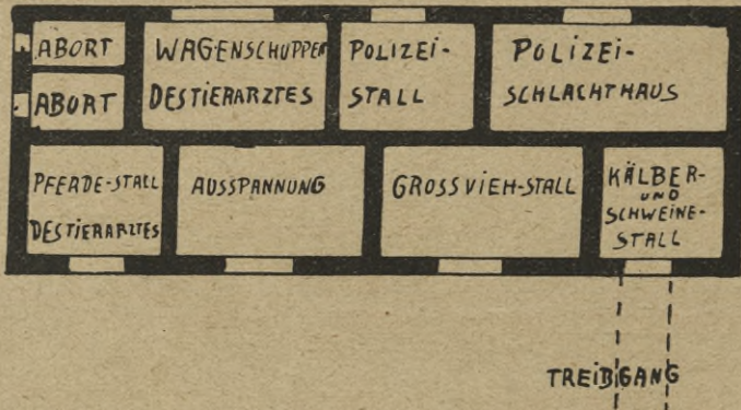
Fig. 22. Mittlere Schlachthofanlagen. Stallgebäude.
