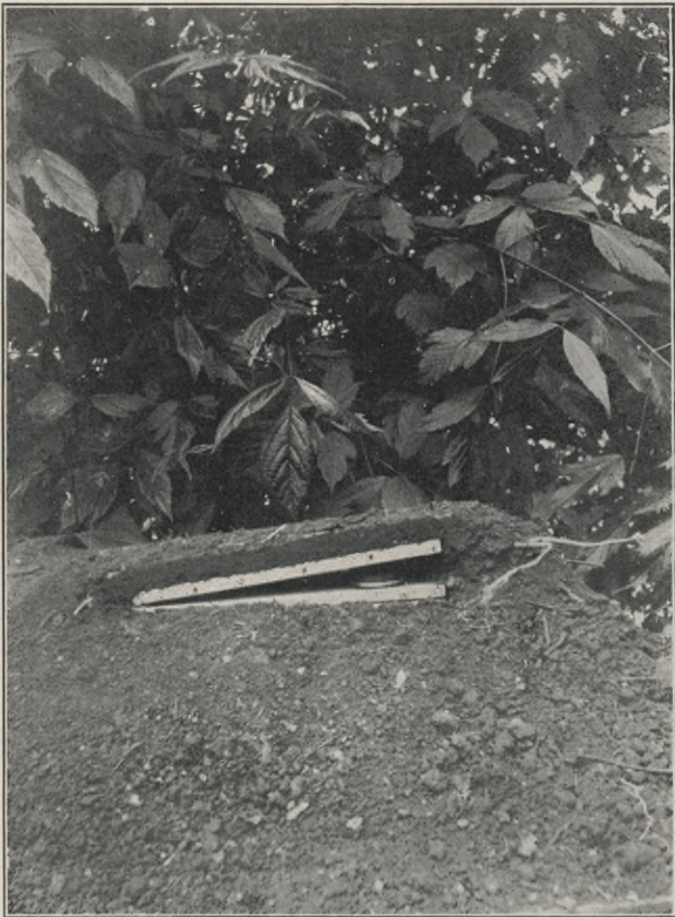
Abb. 15. Abtritt-Kontakt, einfachster Typ,
