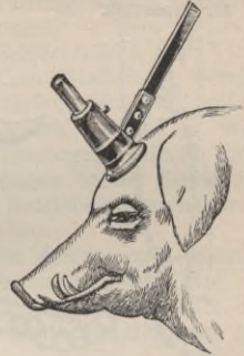
Fig. 170. Schlagbolzenhammer für Hammel.
