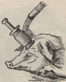
Fig. 169. Schlagbolzenhammer für Kälber.
