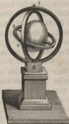
wieder um eine horizontale Aze  $cd$  (der Endpunkt  $d$  ist in unserer Figur verdeckt) innerhalb eines zweiten Ringes drehbar, welcher selbst wieder um eine verticale Aze  $fg$  innerhalb des äußersten auf einem Postamentchen befestigten Ringes gedreht werden kann. Auf diese Weise ist die Kugel sowohl wie ihre Umdrehungsaxe vollkommen frei beweglich.
