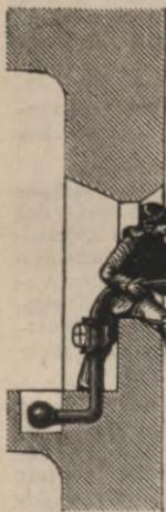
Fig. 26. Anordnung der Löschgänge i. Hof-Opernhause z. Wien.
