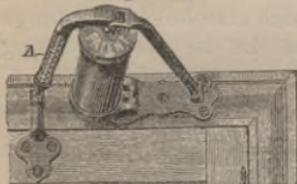
welche mittels eines Pergamentriemens, bezw. eines daran befestigten Hakens, an einer Leitstange angreift, während andererseits an einer Gabel, die durch eine leichte Spannfeder mit der Leitstange verbunden ist, eine Gummipuffer-Kugel angeschraubt ist. Bei Oeffnung der Thür spannt sich die Feder und schleudert dadurch die Thür zu; die Gummikugel hindert aber zunächst den vollständigen Zuschlag. Damit macht die Gabel eine Winkelwendung, in Folge welcher dann der vollständige Schluss
