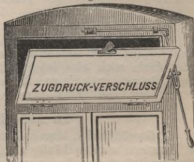
auf das Gelenkgestänge *d—e* bildet. Eine Klemmschraube *i* erlaubt Feststellung des Flügels in willkürlicher Lage. Gelenkstangen *h* verbinden den inneren Flügel mit dem äusseren. Die Fig. A—C und E, F zeigen Vereinfachungen für einflügelige Fenster ohne Schloss wie sie mannigfach für Turnhallen, Fabrikräume, Lagerhäuser usw. angewendet werden.
