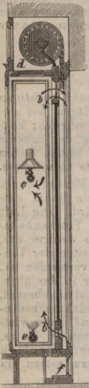
Um das Beschlagen des unteren Fenstertheils sicher zu vermeiden, wird am Fusse der Scheibe oft eine Reihe Flammen (bei *e* in Figur 91) mit entsprechenden Luftöffnungen (*f*) angebracht. Durch den von diesen Lichtern aufsteigenden Strom erwärmte Luft wird die Zuströmung der kalten Luft (durch *b* unten) befördert. Die Nebenlichter *e*, vortheilhaft für die Beleuchtung und Lüftung, beeinträchtigen indess das Auslegen der Waaren im Schaufenster und können auch feuergefährlich werden.
