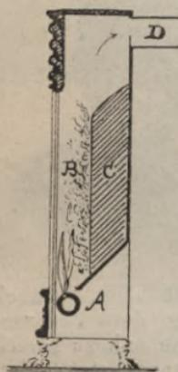
A Rohrbrenner mit entleuchteten Flammen. B Asbestfasern
