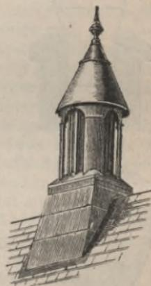
Formen die von R. Boyle & Comp. in London und von Hill & Hay in Halifax gebauten Aufsätze auch in Deutschland eingeführt.<sup>1)</sup> Fig. 250 und 251 stellen einen Boyle'schen Saugkopf in Ansicht und wagrechttem Schnitt dar; letztere Abbildung zeigt die eigenartig gekrümmten Flächen, welche den Wind ablenken.
