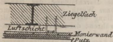
In neuerer Zeit sind auch Eisenfachwerke mit Verwendung von Monierdrahtputz und Gipsdielen für die Ausfachung ausgeführt, worüber das Nöthige weiterhin vermerkt ist.
