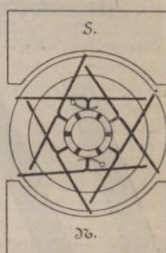
geschieht nach der in Fig. 17 angedeuteten Weise. Eine nähere Betrachtung dieser Figur zeigt, dass durch die Bürsten der Anker zu zwei Hälften parallel geschaltet wird. In jeder Hälfte werden, abgesehen vom Vorzeichen, gleich starke Ströme induziert. Diese eben beschriebene Ringarmatur führt, nach ihren Erfindern, die Bezeichnung *Pacinotti-Gramme'scher Ring*.
