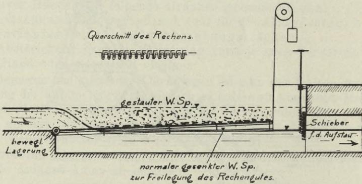
Fig. 53. Fangsieb von Rothe & Co., Berlin (schematisch).
