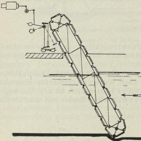
Fig. 57. Rechensystem Brunnotte, Maschinenfabrik Magdeburg-Buckau (schematisch).
