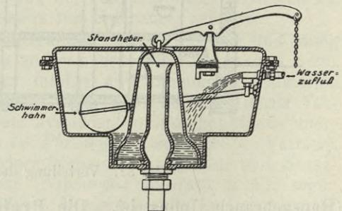
Fig. 35. Standheberspülkasten.
