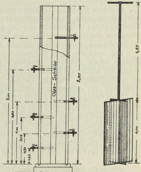
Fig. 61. Stehgefäß für Sedimentationsproben (Kölner Versuche).
