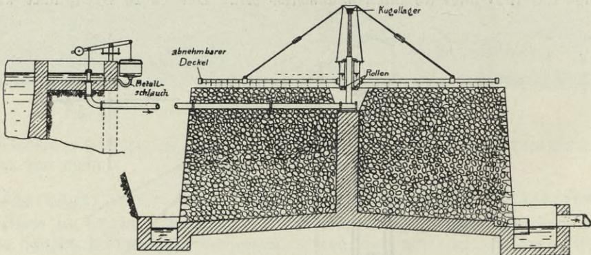
Fig. 86. Drehsprenger mit offenem Sprengertopf ( $\frac{1}{100}$  nat. Gr.).
