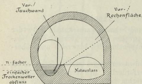
Fig. 46. Notauslaß (Querschnitt).
