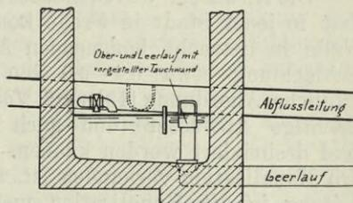
Fig. 89. Kontrollschacht zur Entnahme von Durchschnittsproben (schematisch).
