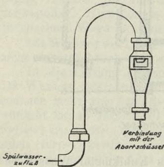
Fig. 34. Rohrunterbrecher.
