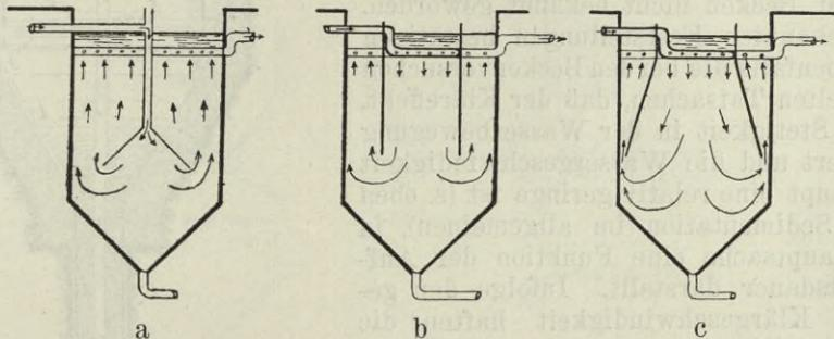
Fig. 67. Ausnutzung des Sedimentiererraums bei Klärbrunnen (schematisch).
