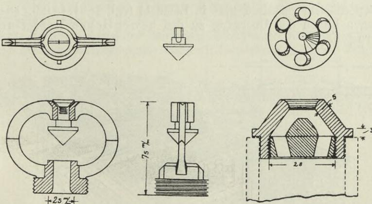
Fig. 80a. Streudüse der Anlage in Columbus N.-A.).
