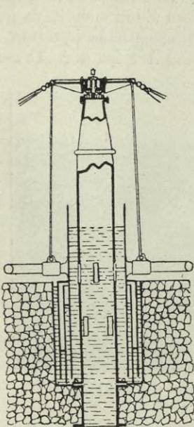
Fig. 84. „Cresset“-Drehsprenger mit Wasserverschluß der Firma Adams, York und London ( $\frac{1}{100}$  nat. Gr.).
