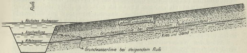
Fig. 11a. Verhalten des Grundwassers bei wechselnden Flußwasserständen.
