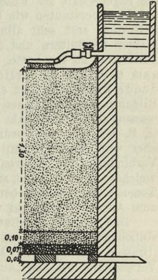
Fig. 17. Sandfilter nach Miquel und Mouchet (Filtre à sable non submergé).
