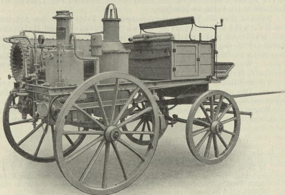
Fig. 36. Fahrbarer Wassersterilisator.
