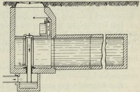
Fig. 49. Spülkammer mit Heberentleerung (Mairich). ( $\frac{1}{100}$  nat. Gr.)
