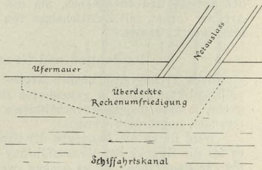
Fig. 47. Notauslaßmündung mit Rechen in der Vorflut.
