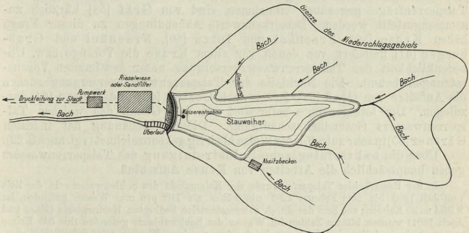
Fig. 13. Grundriß einer Talsperre mit Niederschlagsgebiet usw.
