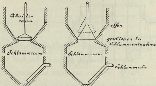
Fig. 69. „Schlamm Schleusen“ (schematisch).
