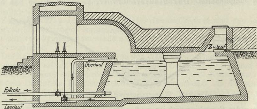
Fig. 26. Sammelbehälter einer Wasserversorgung (Bodenbehälter).
