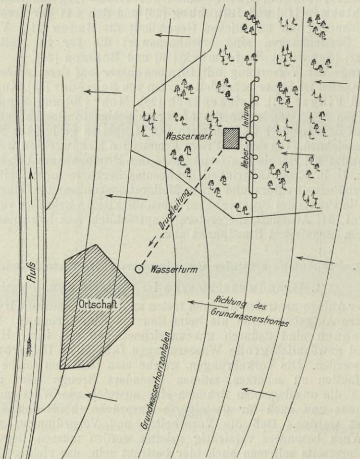
Fig. 10. Höhengichtenplan einer Grundwasserversorgung.
