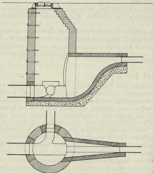
Fig. 44. Einsteigschacht (mit Absturzkonstruktion für den einen Zuflußkanal). (ca.  $\frac{1}{100}$  nat. Gr.)
