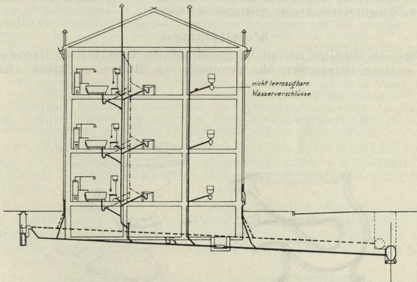
Fig. 40. Schema einer Hausentwässerung. ( $\frac{1}{300}$  nat. Gr.)
