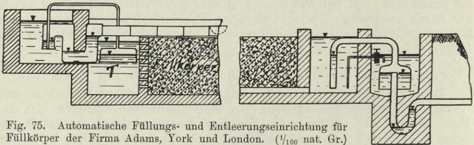
Fig. 75. Automatische Füllungs- und Entleerungseinrichtung für Füllkörper der Firma Adams, York und London. ( $\frac{1}{100}$  nat. Gr.)
