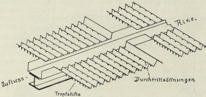
Fig. 78. Verteilungseinrichtung von Stoddart in Bristol (schematisch).
