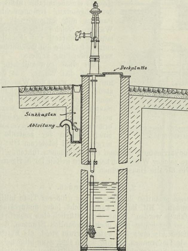
Fig. 5. Kesselbrunnen guter Konstruktion.
