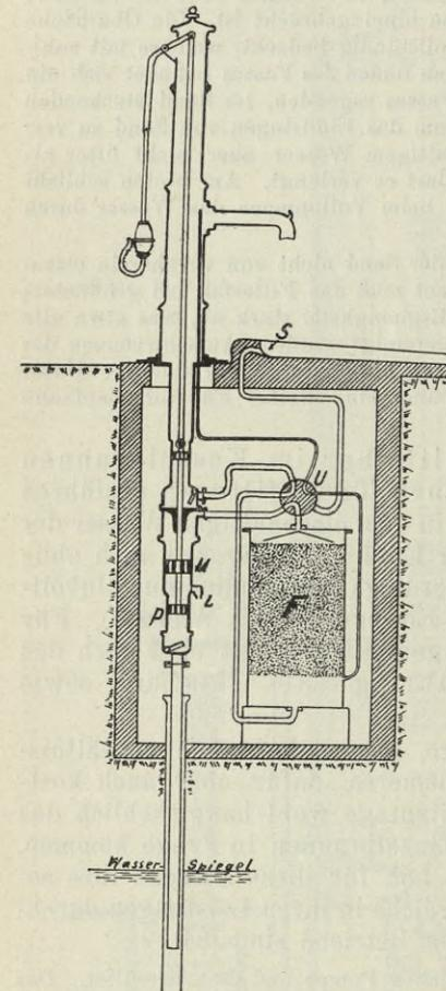
Fig. 22. „Bastardpumpe“ nach Deseinß u. Jacobi mit Filter im Schacht. Halbschematisch. F = Filter, L = Luft-eintritt, M = Mischzylinder, P = Pumpen-zylinder, S = Spülwasseraustritt, U = Umschaltung.
