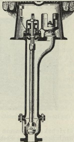
Fig. 29. Unterflurhydrant.
