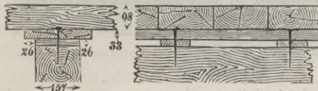
Hängebrücke auf dem Bahnhofe in Gotha. — \frac{1}{15} nat. Gr.
