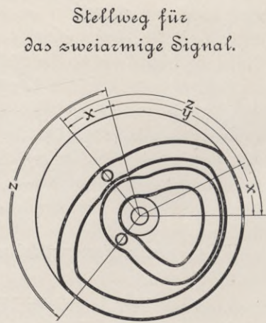
Einseitig angeordnete Hubkurven der Endantriebsrolle für zweiarmige Signale.
