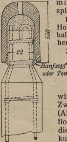
Abb. 209. Eiserner Rammhaube f. Eisenbetonpfähle.
