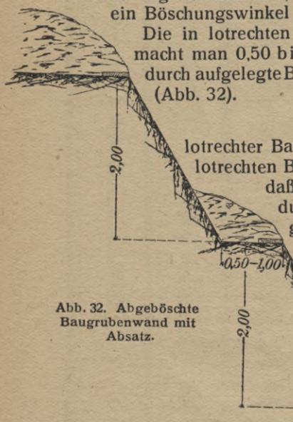
Abb. 32. Abgeboachte Baugrubenwand mit Absatz.
