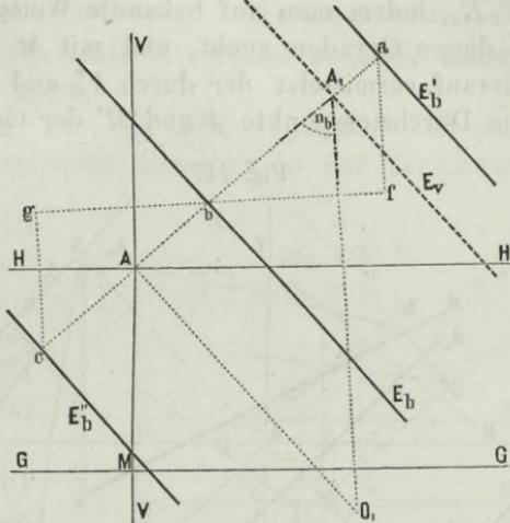
Es ist einleuchtend, dass noch eine zweite Ebene  $E''_b E_v$  den Bedingungen der Aufgabe entspricht, und dass sich deren Bildflächtrace  $E''_b$  im gleichen Abstände, jedoch auf der entgegengesetzten Seite der gegebenen Trace  $E_b$  vorfindet.
