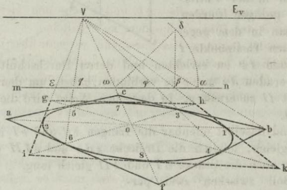
Seiten unzugänglich sind. In einem solchen Falle fällt immer der Verschwindungspunkt  $v$  der einen Diagonale  $cf$  innerhalb der Zeichnungsfläche und kann demgemäss zur Bestimmung der vier Berührungspunkte des Kreises mit dem gegebenen Quadrate, so wie auch zur Verzeichnung der Perspektive eines zweiten Quadrates benützt werden, dessen Seiten gegen jene des ersteren unter einem Winkel von  $45^0$  geneigt sind.
