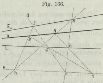
Indem wir  $f$  mit  $p$  verbinden, erhalten wir eine Gerade in der durch  $p$  und  $E_v$  gelegten Ebene.
