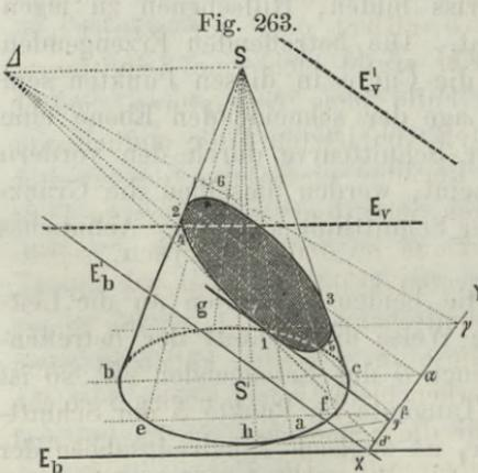
Lösung. Nehmen wir die Horizontalebene  $E_b E_v$  (Fig. 263) als Ebene der Leitlinie,  $S$  als Kegelspitze und die auf  $E_b E_v$  gefällte Senkrechte  $SS'$  als dessen Höhe an; die schneidende Ebene sei  $E'_b E'_v$  und  $xy$  ihr Schnitt mit der Basis-ebene.
