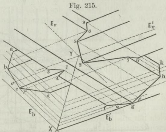
die Hilfsebenen parallel zur Bildfläche gelegt werden müssen, und demnach die Basisebenen in Geraden schneiden, welche zu den Bildflächtracen parallel laufen. Die einzelnen Hilfsschnitte der Prismen sind parallel zu den Kanten und begegnen sich in den zu suchenden Durchschnittspunkten.
