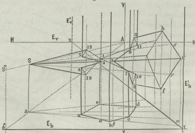
Als Beispiel wurde in Fig. 216 ein auf einer Horizontalebene  $E_b$ ,  $E_v$  senkrecht stehendes fünfseitiges Prisma  $abcde$  mit einer
