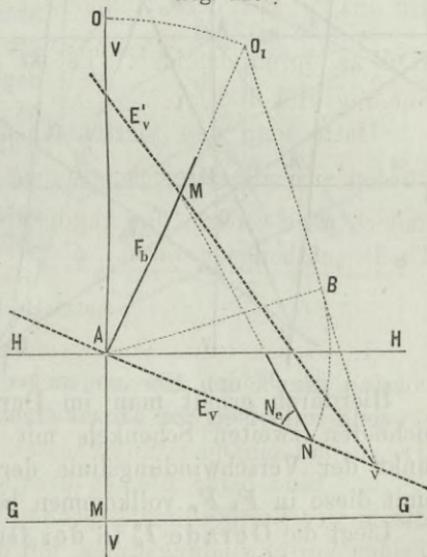
Es ist sodann die aus  $A$  auf den umgelegten Parallelstrahl  $O_1 v$  geführte Senkrechte  $AB$  die Höhe des Dreieckes  $ANM$ , welches bei  $N$  den verlangten Neigungswinkel  $N_e$ , gebildet von den beiden in die Bildfläche niedergelegten Schnittlinien  $MN$  und  $AN$ , enthält.
