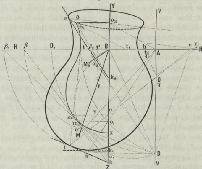
ebene gelegt, z. B. jene, deren Verschwindungslinie die Horizontlinie in  $v$  schneidet, und betrachte diesen Meridian als Leitlinie einer Cylinderfläche, welche die Rotationsfläche in demselben berührt, folglich horizontale, auf der Meridianebene senkrechte Erzeugende besitzt.
