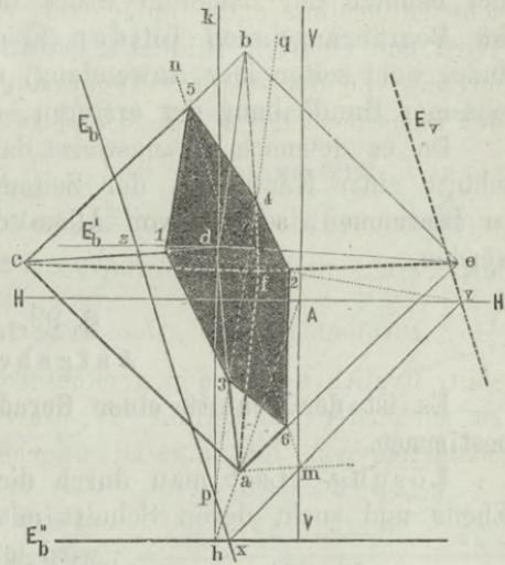
Bemerkung. Aus dem eben Besprochenen ist ersichtlich, dass es nicht zweckmässig gewesen wäre die Durchschnitte der Kanten einzeln zu bestimmen, sondern, dass man hier mit Axenebenen am einfachsten und schnellsten zum Ziele
