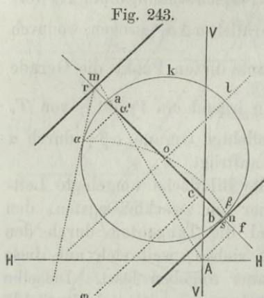
der Ebene des Kreises  $k$  und lege letztere um  $ab$  in die Bildfläche. Der besagte Durchschnittpunkt gelangt hierbei in die Verlängerung der Geraden  $Af$ , in eine der Augdistanz gleiche Entfernung von  $f$ ; seine halbe Entfernung von dem Kreismittelpunkte  $o$  wird mithin erhalten, wenn man  $of$  in  $c$  halbiert,  $c\omega$  senkrecht auf  $ab$  errichtet und der halben Augdistanz gleich macht.
