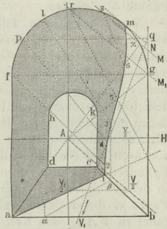
dem Schatten auf die Seitenfläche und in die Cylinderfläche bildet. Diese Gränzlinie ist  $gk$ ; legt man folglich durch  $g$  die Bildflächtrace  $M_1$  parallel zu  $VA$  und zieht durch  $r$  den Lichtstrahl  $rV$ , so wird dieser die Gerade  $gk$  in dem zu suchenden Punkte  $5$  schneiden.
