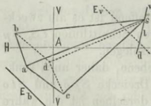
Ist demnach  $abcd$  (Fig. 189) die in der Ebene  $E_b$ ,  $E_v$  gelegene Basis, und  $S$  die durch die Gerade  $l_a^v$  bestimmte Spitze der Pyramide, so hat man diese einfach mit den Eckpunkten des Basispolygons zu verbinden, um die einzelnen Kanten zu erhalten. Beim Verbinden ist überdies noch zu berücksichtigen, welche von den so erhaltenen Kanten sichtbar oder gedeckt erscheinen.
