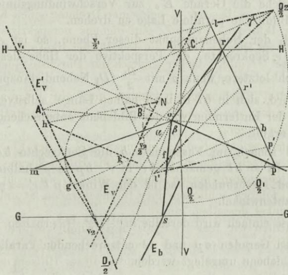
liegt, senkrecht auf die Bildfläche und die Fläche  $sop$  horizontal. Die durch die Kante  $so$  gehende zweite Seitenfläche muss sonach senkrecht auf die Bildebene stehen, daher ihre Verschwindungslinie  $E_v$  durch den Augpunkt  $so$  zu ziehen sein wird, dass sie mit der Horizontlinie  $HH$  den Winkel  $C$  bildet. Die Bildflächtrace  $E_b$  dieser Ebene ist daher durch den Durchstosspunkt  $s$  der Kante  $os$  parallel mit  $E_v$  zu ziehen.
