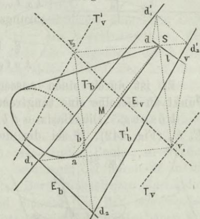
Sucht man die Schnittlinie der beiden Tangirungsebenen, so muss dieselbe durch den Scheitel  $S$  des Kegels gehen.
