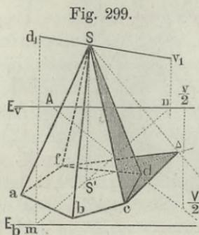
Da die von  $\Delta$  an das Basispolygon gezogenen Verbindungslinien mit den äussersten Ecken  $c$  und  $f$  die zu suchenden Schlag Schattengränzen sind, so werden auch die rückwärts zwischen diesen beiden Kanten  $cS$  und  $fS$  liegenden Seitenflächen im Selbstschatten liegen.
