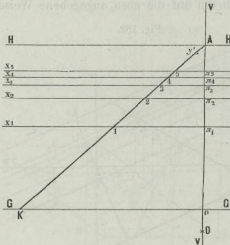
1, 2, 3... die aufeinander folgenden mit den früheren Punkten  $p_1, p_2, p_3 \dots$  identischen, den bekannten Bedingungen entsprechenden Theilpunkte, welche mittelst der Geraden  $x_1, x_2, x_3 \dots$ , die den senkrechten Abstand der Horizonts- und Grundlinie in oberväwhnter Weise theilen, erhalten wurden. Die Geraden  $x_1, x_2, x_3 \dots$  sind hauptsächlich deswegen angegeben, um zugleich die Grundflächtracen von zur Bildfläche parallelen Ebenen darzu-
