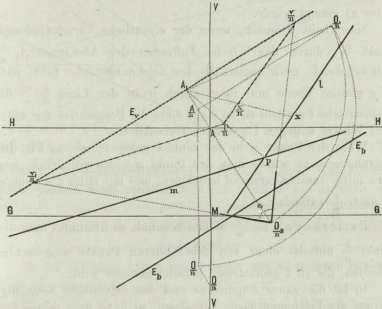
a) In dem Falle, wo bloß der  $n$ te Theil der Augdistanz auf der Zeichnungsfläche zu benutzen möglich ist, wird man sich, falls für die gegebene Gerade der Verschwindungspunkt  $\frac{v}{n}$  nicht bekannt ist, denselben vorerst bestimmen. Zu diesem Zwecke wird die Verbindungslinie irgend eines in der Geraden  $l$  angenommenen Punktes  $x$  mit dem Nebenaugpunkte  $A_1$  in  $n$  gleiche Theile getheilt, also  $A_1 \frac{x}{n} = \frac{1}{n} A_1 x$  gemacht, und durch  $\frac{x}{n}$  eine
