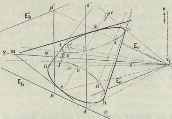
Erzeugenden, welche den Umriss bilden, Hilfsebenen zu legen und wie früher vorzugehen hat. Die betreffenden Erzeugenden werden sodann Tangenten an die Curve in diesen Punkten sein und in jenen Fällen, wo die Lage der schneidenden Ebene eine solche ist, dass ein Theil der Schnittcurve durch den vordern Theil der Fläche gedeckt erscheint, werden dieselben die Gränzpunkte des sichtbaren Theils der Schnittlinie angeben. Aehnliches gilt allgemein für jede Fläche.
