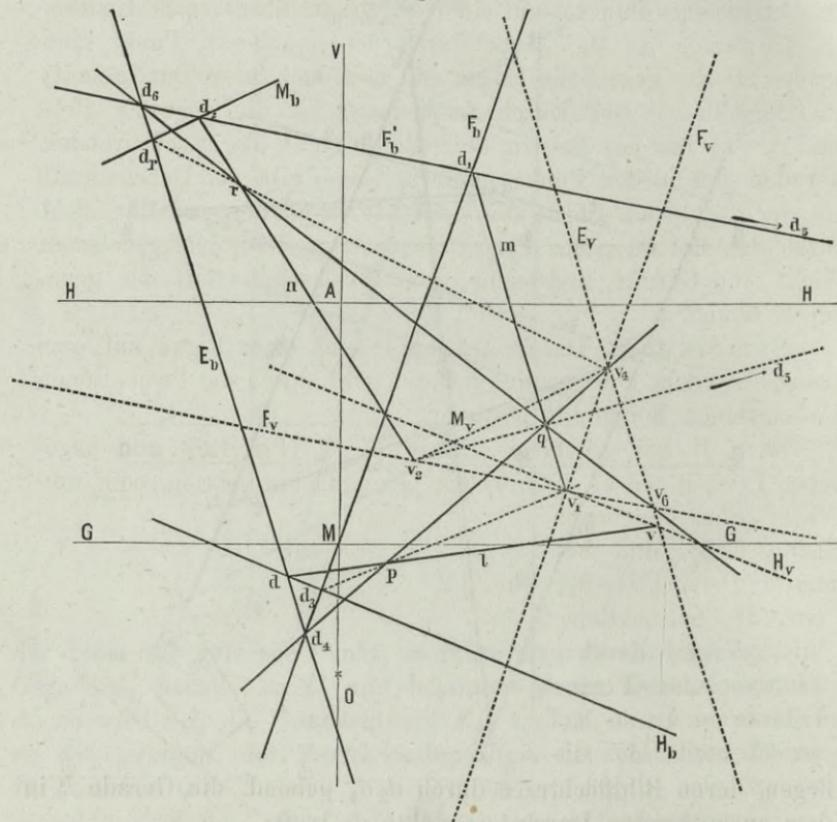
Der Umstand, dass  $E_b$  parallel zu  $E_v$  sein muss, bietet eine Controle für die Genauigkeit der durchgeführten Konstruktionen.
