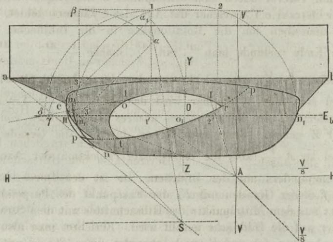
durch die beiden Kanten  $ab$  und  $ac$  gelegten Lichtebenen mit der Umdrehungsfläche zu construiren. Zu diesem Zwecke lege man durch  $a$  den Lichtstrahl  $aV$  und bestimme dessen Durchstoßpunkt  $S$  mit der Bildfläche, welche letztere durch die Umdrehungsaxe gehend angenommen wurde.
