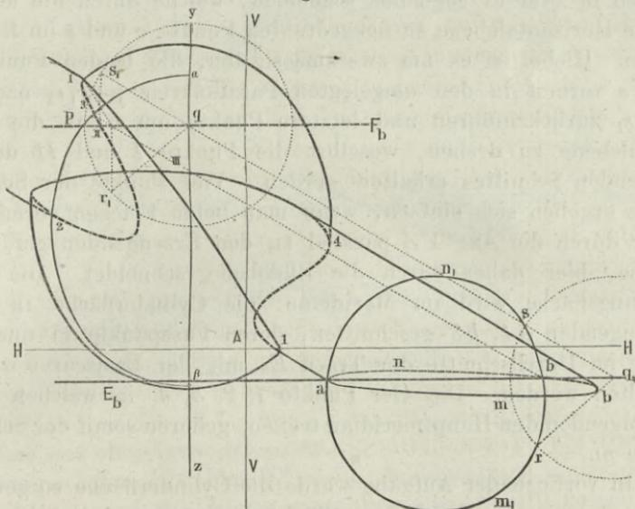
sei  $amn_b$  (Fig. 278) die Trace der Cylinderfläche auf der Horizontalebene  $E_b$  und  $ap\beta$  der Hauptmeridian der Rotationsfläche.
