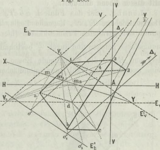
tracen  $\delta \Delta$ ,  $\delta_1 \Delta_1 \dots$  dieser Hilfsebenen gehen durch  $\delta$ ,  $\delta_1 \dots$  parallel mit  $vv_1$  und schneiden die Bildflächtrace  $E_b$  in  $\Delta$ ,  $\Delta_1 \dots$ , wesshalb  $\Delta v_2$ ,  $\Delta_1 v_2 \dots$  die Hilfsschnitte mit der Schnittebene  $E_b E_v$  sind, welche den entsprechenden Kanten in 2, 3... begegnen.
