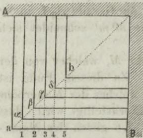
Das Profil in der Mauerfläche  $B$  (Fig. 324) wird auf bekannte Art (siehe §. 163) und wie aus der Figur ersichtlich, gefunden. Es werden nun noch die Bilder der vertikalen Kanten der Stufen (in der freien Ecke derselben) zu bestimmen sein. Betrachten wir den Grundriss (Fig. 323), so ist ersichtlich, dass sich die horizontalen Projektionen  $\alpha, \beta, \gamma \dots$  dieser Kanten als die Eckpunkte der Diagonalen von Quadraten ergeben, welche die Stufenbreite zur Seite haben.
