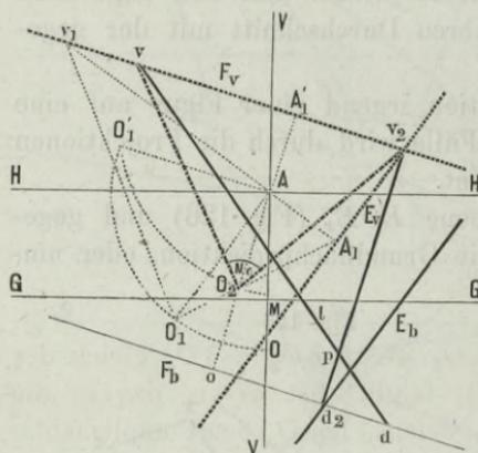
Wir haben demnach den Verschwindungspunkt  $v_1$  aller auf der Ebene  $E_b E_v$  senkrecht stehenden Geraden zu ermitteln, und diesen mit  $v$  zu verbinden, um die Verschwindungslinie  $F_v$  der durch  $l_d^v$  auf  $E_b E_v$  senkrecht geführten Ebene  $F_b F_v$  zu erhalten.
