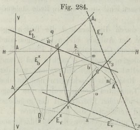
wird. Alsdann drehe man die Parallelebene sammt dieser Kegeltrace und dem Auge um  $E_v$  in die Bildebene, woselbst  $g$  als Kreismittelpunkt nach  $o$  gelangt. Aus  $o$  ist der Kreis mit dem Radius  $bk$  zu beschreiben.
