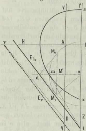
Parallelkreises. Der Punkt  $M$  sei durch seine orthogonale Projektion  $M'$  auf der Hauptmeridianebene angenommen worden. Es ist sodann  $M_2 m M_1$  der parallel zur Bildfläche gedrehte Parallelkreis, daher unserer Annahme die beiden Punkte  $M_1$  und  $M_2$  der Oberfläche entsprechen.  $AD$  sei die Augdistanz.
