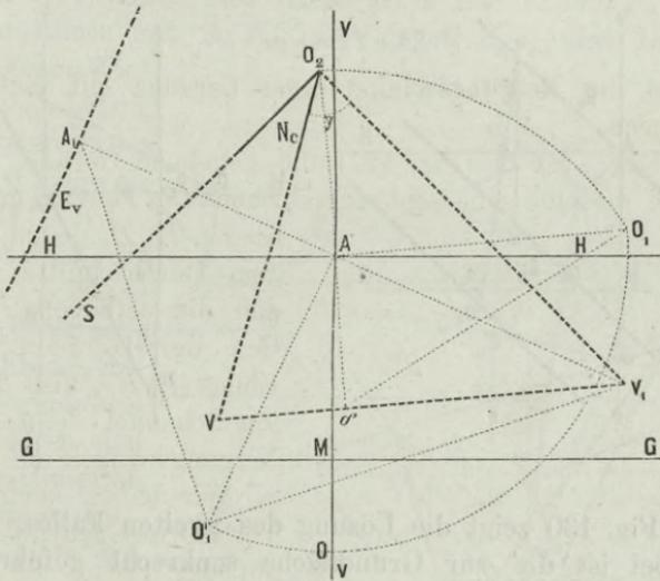
Hiebei fällt das Auge nach  $O_2$  (wenn  $\delta O_2 = \delta O_1$  gleich der Nebenaugdistanz gemacht wird), folglich ist  $v O_2 v_1$  das in die Bildebene niedergelegte Dreieck, welches bei  $O_2$  den Complementswinkel  $y = 90 - N_c$  enthält, weshalb blos in  $O_2$  die Senkrechte  $O_2 S$  auf  $O_2 v_1$  zu errichten ist, um in  $v O_2 S$  den verlangten Neigungswinkel zu erhalten.
