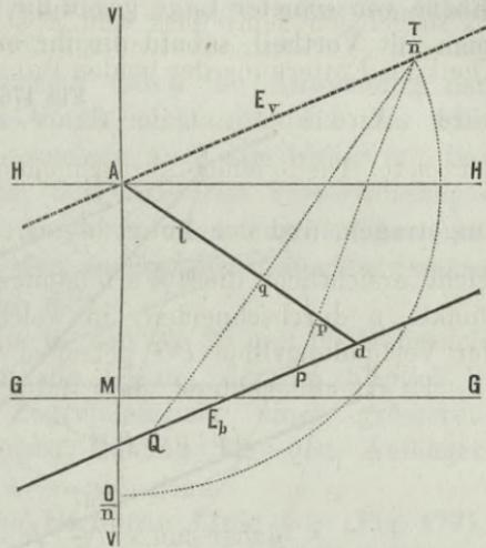
In Fig. 175 wurde von dem auf  $l$  gelegenen Punkte  $p$  auf der Geraden  $l$  ein  $n$  mal so grosses Längenstück abgeschnitten, als dasjenige, was von  $P$  nach  $Q$  aufgetragen ist.
