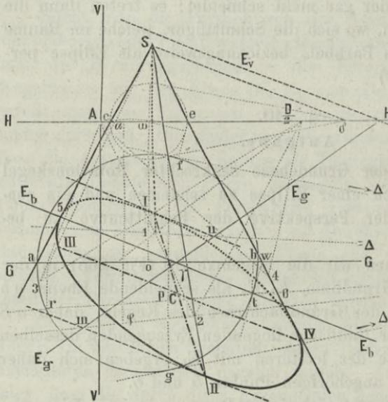
die Grundflächtracen der in Rede stehenden Berührungsebenen sind. Weil  $\Delta$  nicht benützt werden kann, so wurden noch zwei andere Punkte der Geraden  $f\Delta$ ,  $g\Delta$  zurückgedreht und mit 1 und 2 verbunden.
