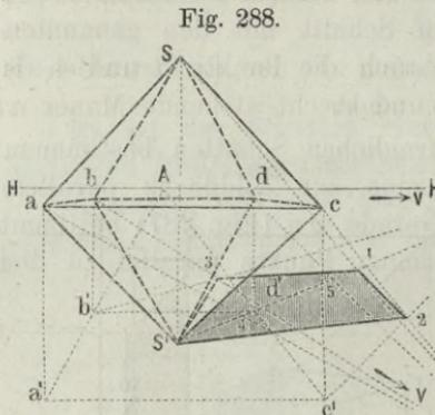
funden, sich auch sein Schatten auf dieser Ebene sehr einfach ergibt. Bei den regelmässigen Körpern ist die orthogonale Projektion der Eckpunkte leicht verzeichnet; es wird demnach auch die Bestimmung des Schlagschattens keinen Schwierigkeiten unterliegen. In unserem Falle ist die horizontale Projektion aller Punkte durch die Verzeichnung des Quadrates  $a'b'c'd'$  über der Oktaederkante, wobei
