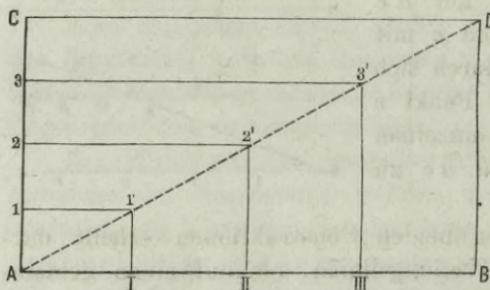
geführt, nachdem deren Perspektiven auf den Verschwindungspunkt  $v$  der Geraden  $ab$  zugehen. Die Diagonale  $AD$ , entsprechend der Geraden  $ad$  des Bildes, wird mithin in den Punkten  $1', 2', \dots$  in  $n$  gleiche Theile getheilt, wesshalb
