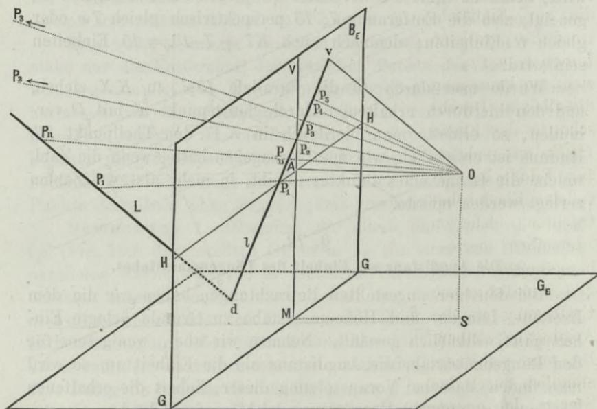
Dieses Ergebniss sagt aus, dass mit der Zunahme von  $n$ , also bei grösser werdender Entfernung des hinter der Bildfläche gelegenen Punktes  $P_n$  die Perspektive  $p_n$  sich nach einem bestimmten, durch die eben erhaltenen Gleichungen ausgedrückten Gesetze ununterbrochen dem Punkte  $v$  nähert.
