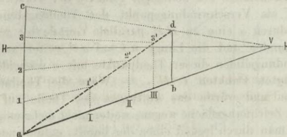
punkt  $c$  der so erhaltenen Länge mit dem Verschwindungspunkte  $v$  der gegebenen Geraden  $ab$  verbindet, ferner die Vertikale  $bd$  errichtet und die Diagonale  $ad$  zieht.
