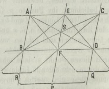
als die Perspektive der Geraden  $EF$ , welche das durch  $abcd$  dargestellte Parallelogramm  $ABCD$  (Fig. 165) in zwei perspektivisch gleiche Parallelogramme  $abef$  und  $efcd$  theilt. Denn  $ef$  geht durch den Mittelpunkt des Parallelogrammes und ist parallel
