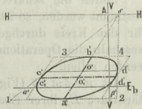
Gebrauch machen. Es wird also  $cd$  nach  $c'd'$  zu übertragen,  $c'$  und  $d'$  mit  $\delta$  (d. i. der Verschwindungspunkt des Durchmessers  $ab$ ) zu verbinden, sowie  $12$  und  $34$  durch  $a'$  und  $b'$  parallel zu  $E_b$  zu ziehen sein, um das Trapez  $1234$  zu erhalten, dessen Seiten Tangenten an die Perspektive der Ellipse in den Punkten  $a'$ ,  $b'$ ,  $c'$ ,  $d'$  sind.
