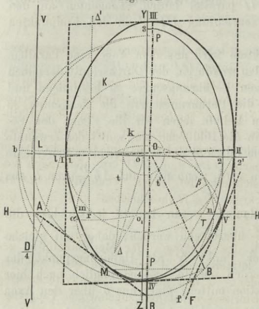
nämlich die beiden an den umgelegten grössten Parallelkreis  $K$  zu ziehenden Tangenten  $T$  und  $T'$  parallel zu jenen Tangenten  $t$  und  $t'$  geführt, welche man aus  $\Delta$  an den Kreis  $k$ , dessen Radius  $\frac{1}{4} \cdot 01$  ist, führte.
