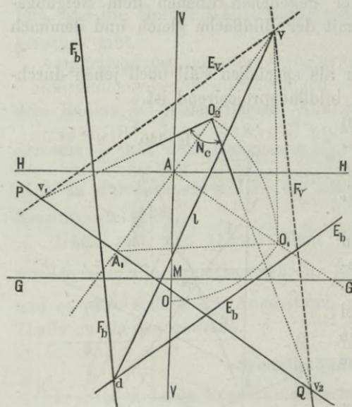
Verschwindungslinie der verlangten Ebene zu erhalten. Es wird also bloß auf die in  $vA$  projectirte und nach  $vO_1$  umgelegte Durchschnittslinie durch das Auge eine senkrechte Ebene (mittelst  $O_1 A_1$ )  $PQ$  zu führen, hierauf die Durchschnittsgerade der gegebenen Parallelebene in die Bildfläche nach  $O_2 v_1$  umzulegen, und an diese Linie, als den einen Schenkel des Neigungswinkels, der gegebene Winkel  $N_e$  aufzutragen sein.
