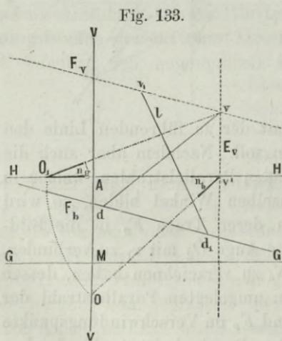
gegen die Horizontlinie  $HH$  unter dem gegebenen Winkel  $n_b$  gezeichnete Linie  $Ov'$  in  $v'$  einen Punkt der Verschwindungslinie  $E_v$  derjenigen vertikalen Ebene angibt, welche die verlangte Gerade in sich enthält. Man findet nämlich in der Verschwindungslinie  $E_v$ , welche senkrecht auf der Grundebene steht, die Trace der entsprechenden Parallelebene, die demnach auch den der zu ziehenden Geraden zugehörigen Parallelstrahl in sich enthalten muss.
