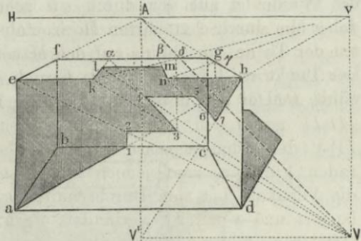
Gerade  $\beta\alpha$  bis zum Durchschnitte  $4$  mit  $lv$  zu ziehen ist und, wie schon früher gezeigt wurde, parallel zu  $AV$  sein muss. Die Horizontale  $45$  ist der Schatten von  $lm$ , so wie die Gerade  $56$ , auf den Durchschnittspunkt  $\beta$  von  $mn$  und  $fg$  zu-
