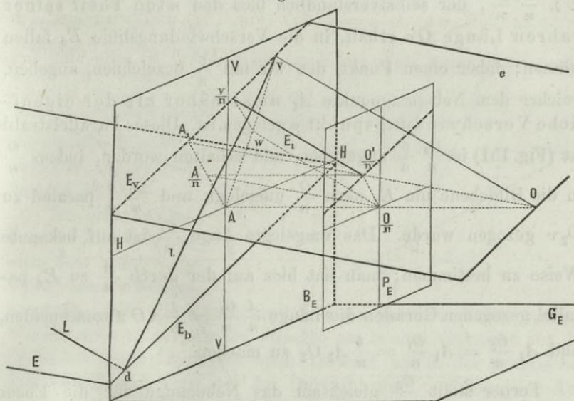
und auf der Verschwindungslinie  $E_v$  senkrechten Ebene  $E_1$  so lange verschoben, bis dieses in die vorerwähnte Parallelebene fällt. Dieses wird offenbar dann eintreten, wenn man statt des Punktes  $A$  einen solchen Punkt  $\frac{A}{n}$  als den Augpunkt betrachtet, der von dem Nebenaugpunkte  $A_1$  eine  $n$ mal kleinere Entfernung, als der Punkt  $A$  besitzt; denn die beiden Dreiecke  $A_1 A O$  und  $A_1 \frac{A}{n} \frac{O'}{n}$  sind ähnlich und in Folge dessen ist
