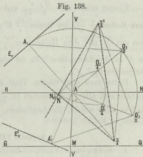
Denn trägt man auf der zu  $AA_1$  Senkrechten  $\frac{AO_1}{2}$  anstatt der Distanz  $AO$  bloß einen aliquoten Theil, hier  $\frac{AO}{2}$  auf, verbindet  $A_1$  mit  $\frac{O_1}{2}$ , und errichtet wie vorher in  $\frac{O_1}{2}$  auf  $A_1 \frac{O_1}{2}$  eine Senkrechte  $\frac{O_1}{2} \frac{v}{4}$ , so trifft diese die Gerade  $AA_1$  in einem Punkte
