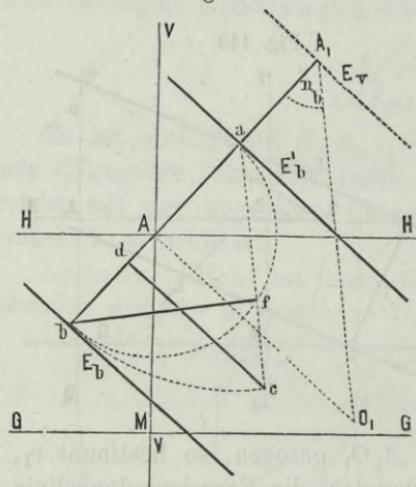
Durchschnittspunkt mit  $a$  verbunden, so bilden diese drei Geraden  $ab, ax, bx$  ein bei  $x$  rechtwinkliges Dreieck, dessen Hypotenuse  $ab$  ist, und worin der dem Abstände  $bx$  gegenüberliegende Winkel dem Neigungswinkel  $n_b$  der gegebenen Ebene mit der Bildfläche gleich kommt.
