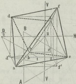
Um nun die Entfernung der beiden Flächen  $abc$  und  $def$  zu bestimmen, denke man sich in  $h$  eine auf die Kante  $ab$  senkrechte, also zur Bildfläche parallele Ebene geführt, so wird dieselbe das rechtwinklige Dreieck  $dd'h$  enthalten, dessen Spitze  $d$  gefunden wird, indem man die in  $d'$  errichtete Vertikale aus  $h$ , als Mittelpunkt, mit dem Radius  $hc$  durchschneidet, wodurch sich in  $dd'$  die gewünschte Entfernung ergibt.
