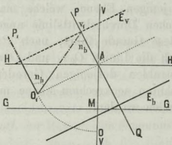
(Fig. 136) mit der Bildebene, und nicht, wie früher angenommen wurde, den Neigungswinkel der beiden Parallelebenen aufsucht. Es ist sodann  $PQ$  die Trace der durch das Auge senkrecht auf  $E_v$  (das ist die Durchschnittslinie der beiden Ebenen) geführten Ebene, folglich  $O_1$  das um  $PQ$  umgelegte Auge, und  $O_1 v_1 Q = n_b$  der gewünschte Neigungswinkel.
