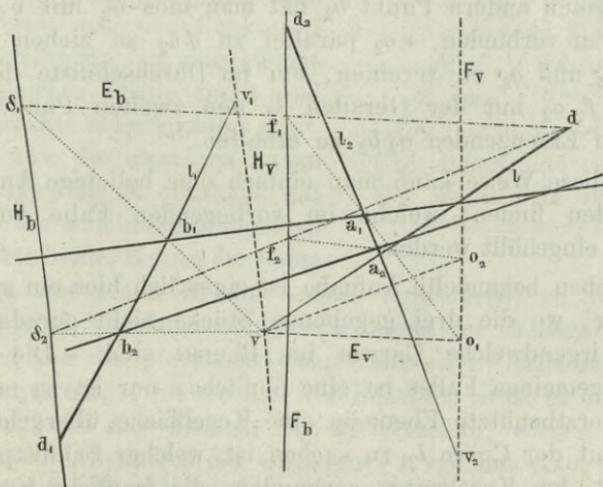
durch denselben und durch eine der beiden andern Geraden, z. B. durch  $l$ , eine Ebene und bestimme den Schnitt  $a_1$  der dritten Geraden  $l_2$  mit dieser Ebene. Die Verbindungslinie  $a_1 b_1$  der beiden Punkte  $a_1$  und  $b_1$  wird sodann eine Erzeugende der zu bestimmenden Fläche sein.
