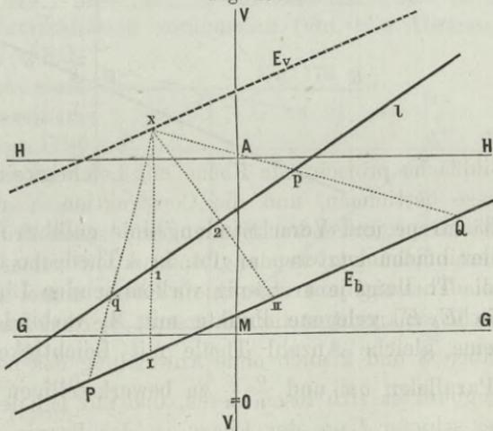
Werden nämlich die Punkte  $p$  und  $q$  mit  $x$  verbunden, und hierdurch  $P$  und  $Q$  auf  $E_b$  erhalten, so wird man nur  $PQ$  nach dem vorgegebenen Verhältnisse zu theilen, und die entsprechenden Theilpunkte  $I, II$  etc. mit  $x$  zu verbinden haben, um so in den Durchschnitten der zugehörigen Verbindungslinien mit  $p q$ , d. i. in den Punkten
