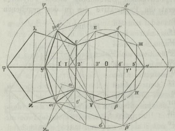
zu ermitteln; denn es ist  $\rho 2'$  die Projektion von  $2'\varphi$  und  $2'1'$  die Projektion von  $2'4'$ , somit die Höhen der beiden Punkte  $\rho$  und  $\alpha'$  aus den beiden rechtwinkligen Dreiecken  $2'1'\psi'$  und  $2'\rho\psi$ , welche die genannten Projektionen als die einen Katheten
