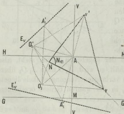
Denkt man sich durch das Auge zwei Gerade senkrecht auf die gegebenen Ebenen gelegt, so sind, nach §. 39,  $v$  und  $v'$  (Fig. 137) die Verschwindungspunkte derselben, mithin  $vv'$  die Verschwindungslinie jener Ebene, welche auf der Schnittlinie der beiden gegebenen Ebenen senkrecht steht, und durch die senkrecht geführten Geraden geht. Diese beiden Geraden schliessen
