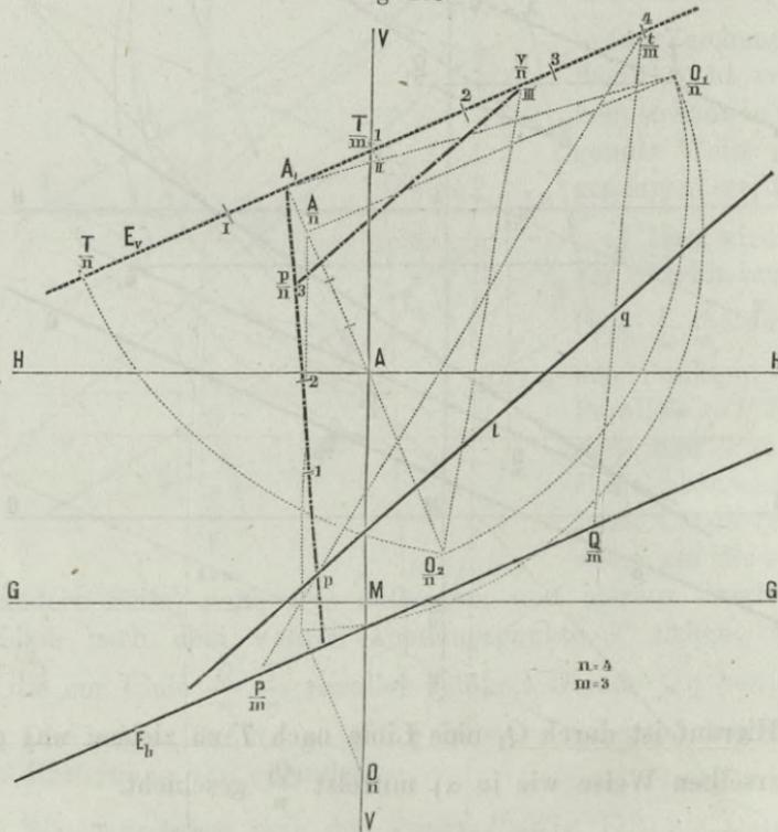
In Fig. 173 ist  $l$  die gegebene, in der Ebene  $E_b E_v$  liegende Gerade, und  $p$  ein Punkt derselben, von welchem ausgehend ein bestimmtes Längsstück  $PQ = a$  der Geraden  $l$  abgeschnitten werden soll.
