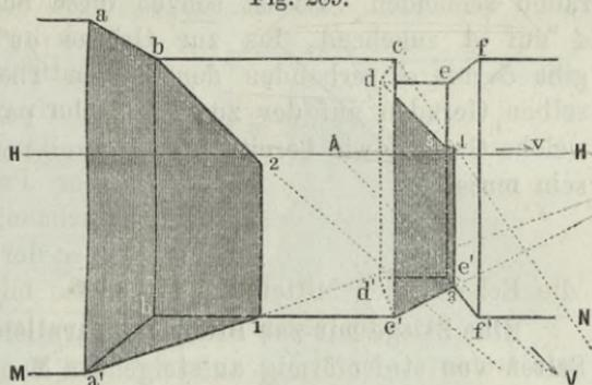
der Bildfläche stehenden, zu den Lichtstrahlen parallelen Ebene mit der zur Bildfläche parallelen Mauerebene  $bc$ , wesshalb ihr Schnitt parallel zur Bildflächtrace der ersteren Ebene, also auch parallel zu ihrer Verschwindungslinie  $VA$  sein wird.
