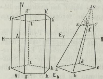
In derselben Figur wurde durch  $hfgkl$   $k'f'g'k'l'$  ein zweites Prisma perspektivisch dargestellt, bei welchem der Verschwindungspunkt der parallelen Kanten in unendliche Entfernung fällt, d. h. dessen Kanten eine zur Bildfläche parallele Lage haben. In diesem speciellen Falle sind sonach auch die Perspektiven der Prismenkanten zu einander parallel.
