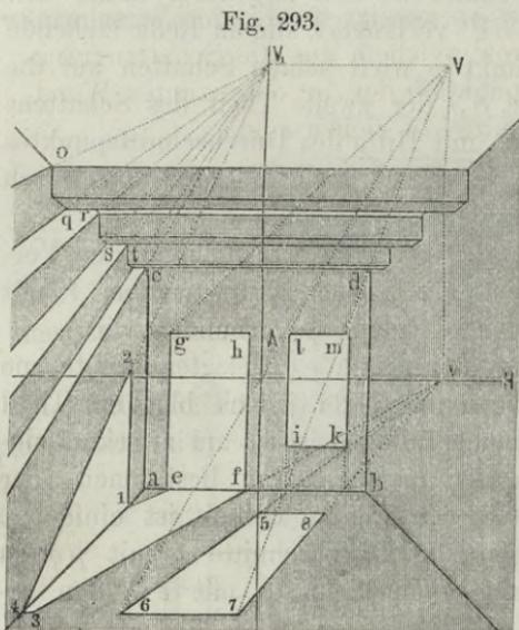
In dieser Wandfläche befinde sich die Thüröffnung  $efgh$  und die Fensteröffnung  $iklm$ . Unserer Annahme gemäss muss der Verschwindungspunkt  $V$  der parallelen Lichtstrahlen oberhalb der Horizontslinie liegen, und es wäre demnach, wenn z. B. die Beleuchtung durch die Sonne geschähe, in diesem Punkte das Bild der Sonne zu verzeichnen.
