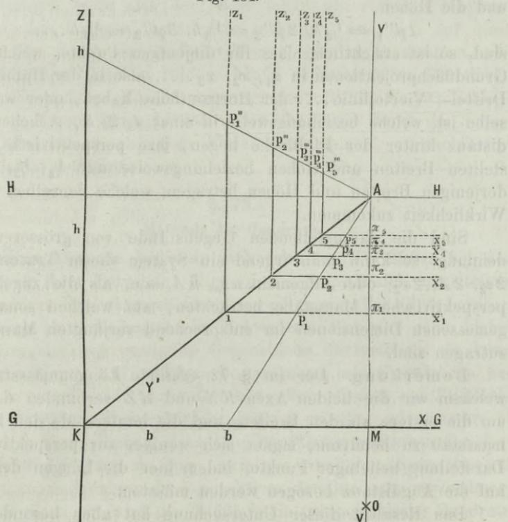
gleichsam in  $KX$  den Breiten- und in  $KZ$  den Höhenmassstab zu erhalten, und trägt man auf diesen Axen die wirkliche Breite und Höhe irgend eines Punktes  $P$  auf, so dass die erstere nach  $Kb = b$ , die letztere nach  $Kh = h$  fällt, und verbindet sodann die beiden Punkte  $h$  und  $b$  mit dem Augpunkte  $A$ , so wird man in den Durchschnitten der Linie  $bA$  mit den auf einander folgen-
