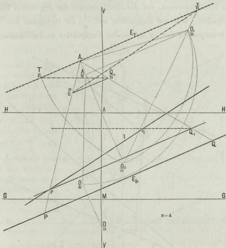
Hierauf ist durch  $Q_1$  eine Linie nach  $T$  zu ziehen, was ganz in derselben Weise wie in  $\alpha$ ) mittelst  $\frac{Q_1}{n}$  geschieht.
