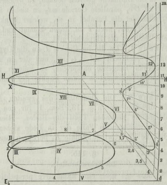
Peripherie in eine beliebig grosse Anzahl gleicher Theile zu theilen sein. Die in den Theilpunkten errichteten Vertikalen werden sodann die einzelnen Lagen der Erzeugenden einer Cylinderoberfläche vorstellen, welche sämmtlich von der zu verzeichnenden Curve so geschnitten werden, dass der Höhenunterschied je zweier Durchschnittspunkte dem zwischen den betreffenden Erzeugenden
