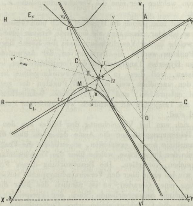
sich in dem Mittelpunkt  $c$  der Perspektive, welchem in der Ebene der Hyperbel der Punkt  $C$  entspricht. Werden endlich die Asymptotenwinkel  $v_1cv_2$  und  $v_1ct'$  halbirt, so geben die Halbierungslinien  $cv$  und  $IIIIV$  die Richtungen der beiden senkrechten Axen, von welchen diejenige die reelle ist, deren zugehörige Gerade im Raume eine Sehne der gegebenen Hyperbel wird.
