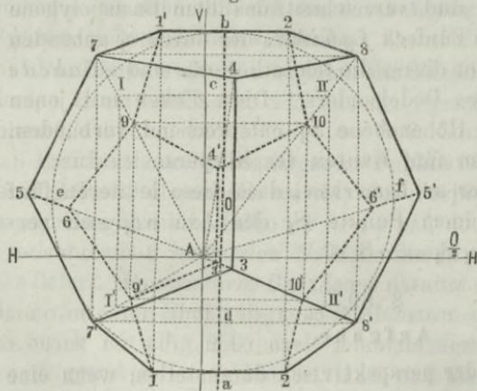
handelt sich hier vorzugsweise um die Höhe der beiden Punkte  $7'$  und  $8'$ , welche sich einfach ermitteln lässt. Wird nämlich  $\alpha\beta$  (Fig. 202) gleich 12 (Fig. 201) gemacht, über dieser Seite ein regelmässiges Fünfeck beschrieben, und mit der Diagonale desselben als Seite ein Quadrat  $\gamma\delta\epsilon\varphi$  so verzeichnet,
