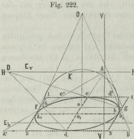
dessen Seiten parallel, beziehungsweise senkrecht zur Bildebene sind, folglich  $a, b, c, d$  die Perspektiven der vier Berührungspunkte und  $ab$  das perspektivische Bild des zur Bildfläche parallelen Durchmessers. Wird nun über  $ab$  ein Kreis  $K$  beschrieben, so kann, wie schon aus dem vorhergegangenen Paragraphen ersichtlich ist, die Kreisperspektive mit Hilfe des Kreises  $K$  gefunden werden, indem man berücksichtigt,
