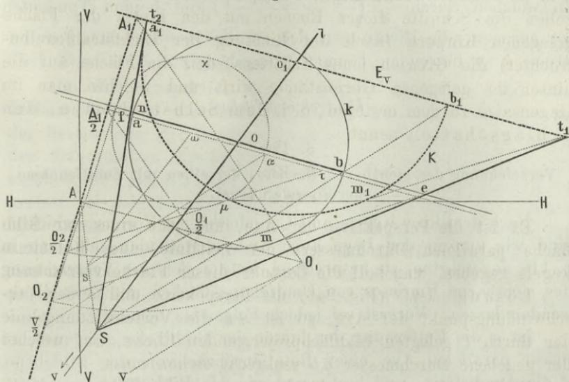
Contouren geben, werden von der Ebene  $E_v$  in zwei Geraden  $O_2 m_1 t_1$ ,  $O_2 t_2$  geschnitten, welche den Kreis  $K$  berühren, durch  $O_2$  gehen und die Trace  $E_v$  in den Punkten  $t_1$  und  $t_2$  der Contourgeraden  $S t_1$  und  $S t_2$  treffen.
