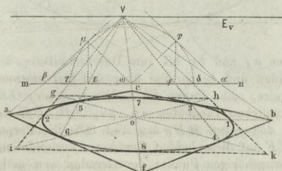
dem Radius  $\omega\nu$  ein Kreis beschrieben, so schneidet er die Gerade  $mn$  in den Punkten  $\delta$  und  $\gamma$ , welche sammt den Punkten  $\varphi$  und  $\varepsilon$ , die durch die Senkrechten  $v\varphi, \mu\varepsilon$  ( $\omega\varphi = \omega\varepsilon$ ) erhalten werden, in derselben Weise wie im vorigen Beispiele zu benützen sind, um die Punkte  $1$  bis  $8$  der Kreisperspektive, so wie das
