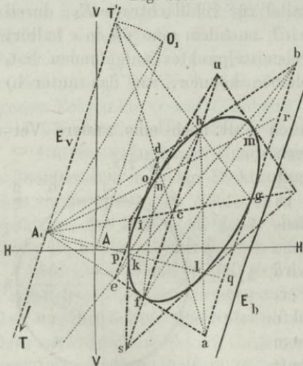
ermitteln sofort in der Art, wie es aus dem Obigen hervorgeht, die Perspektiven der vier Punkte  $K, L, M$  und  $N$ , d. i. die Punkte  $k, l, m$  und  $n$ , so wird man im Stande sein, vermittelst der so erhaltenen acht Punkte und vier Tangenten wenigstens kleinere Ellipsen hinreichend genau zu verzeichnen.
