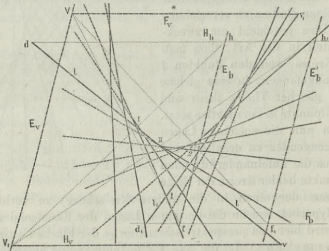
Erzeugenden parallel sein sollen, so nehme man irgend eine zu  $E_v$  parallele Gerade  $E_b$  als Bildflächtrace an und bestimme die Durchschnittspunkte dieser Ebene  $E_b E_v$  mit den beiden Geraden  $l$  und  $l_1$ . Zu diesem Behufe lege man durch jede dieser Geraden eine Ebene  $F_b F_v, H_b H_v$ , welche für die Bestimmung aller weitem Lagen der Erzeugenden zu benutzen sein werden. Es ist sodann  $V$  der Verschwindungspunkt aller Schnittlinien der Ebene  $F_b F_v$
