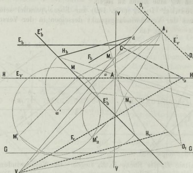
drei Punkte  $M, M'_1, M'_2$  geht, und  $w$  die Perspektive des in die Ebene  $E'_b E'_v$  zurückgeführten Mittelpunktes, so hat man bloß  $w$  mit dem Verschwindungspunkte  $v$  aller auf  $E'_b E'_v$  senkrechten Geraden zu verbinden, und den Durchschnitt  $C$  dieser Verbindungslinie mit der gegebenen Ebene  $E_b E_b$  aufzusuchen, um den gewünschten Punkt zu erhalten, welcher gleichsam als Mittelpunkt einer Kugel zu betrachten ist, deren Oberfläche die drei gegebenen Punkte enthält.
