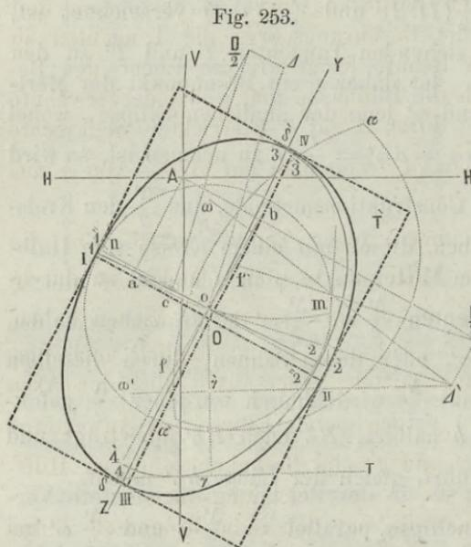
diesem Zwecke  $a \frac{D}{2}$  senkrecht auf  $12$  und gleich der halben Augdistanz gemacht,  $oa$  in  $c$  halbirt,  $o\Delta$  parallel zu  $c \frac{D}{2}$  gezogen,  $o\Delta = c \frac{D}{2}$  abgeschnitten und aus  $\Delta$  der Kreisbogen  $mon$  bis zum Durchschnitte  $m$  und  $n$  mit dem umgelegten Parallelkreise geführt, welche Punkte zurückgedreht in ihren Perspektiven  $I$  und  $II$  die Eckpunkte des einen Durchmessers  $III$
