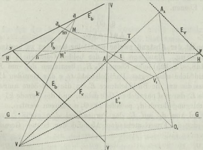
Punkt, welcher durch die Gerade  $l_a^v$  bestimmt ist, so lege man durch denselben eine Gerade  $k_a^v$  senkrecht auf die gegebene Ebene  $E_b E_v$ , indem man auf bekannte Weise den Verschwindungspunkt  $v$  dieser Geraden sucht, und mit  $M$  verbindet. Bestimmt man hierauf vermittelst der durch  $k_a^v$  und  $l_a^v$  gelegten Ebene  $E'_b E'_v$  die Durchstosspunkte  $d$  und  $M'$  der Geraden  $k_a^v$ , beziehungsweise
