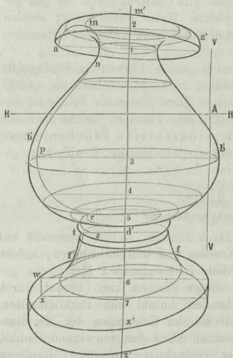
meridians, so geben die über  $a1, m2, p3, \dots$  als Radien verzeichneten Kreisperspektiven, welche von der Curve  $a'b'd'f', \dots$  berührt werden, das perspektivische Bild der Umdrehungsfläche.
