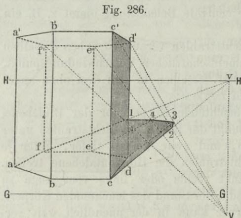
der Tracen der parallel zu den Lichtstrahlen und den Prismenkanten gelegten Ebenen mit der Grundebene  $GG$ , also den Verschwindungspunkt  $v$  dieser Tracen, welcher sich ergibt, indem man in  $V$  die Vertikale  $Vv$  zieht, und diese mit der Horizontlinie zum Durchschnitt bringt.  $v$  kann auch als der Verschwindungspunkt der Projektionen
