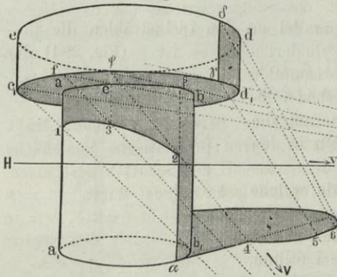
Ziehen wir demnach die Trace  $fv$  einer solchen Hilfsebene, so schneidet diese die Leitlinien in  $e$  und  $f$  und die beiden Cylinder in den Erzeugenden  $e\beta$  und  $fV$ , in deren Durchschnitt der Punkt  $\beta$  der Schattengränze liegt. Auf diese Weise können beliebig viele Punkte der Schattengränze ermittelt werden.
