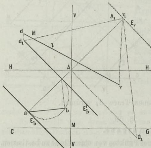
mit der Bildebene und der Ebene  $E_b E_v$ , und legt durch die Gerade  $k_a^v$  die bildflächprojicirende Ebene  $F_b F_v$ , bestimmt ferner den Theilungspunkt  $T$  der Geraden  $k_a^v$ , und mit Hilfe desselben die wahre Länge  $mn$  des perspektivischen Bildes  $MM'$ , so liefert  $mn$  den zu suchenden Abstand.
