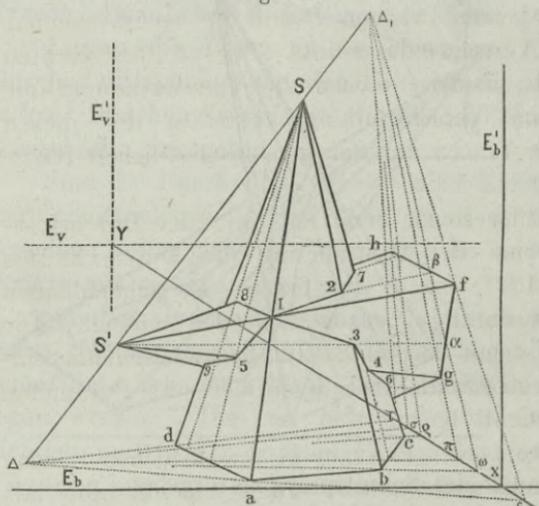
den Basisebenen, so wie den Schnitt  $XY$  dieser letzteren. Die Tracen einer jeden Hilfsebene auf den Basisebenen werden beziehungsweise durch die Punkte  $\Delta$  und  $\Delta_1$  gehen und sich in einem Punkte der Geraden  $XY$  treffen müssen.
