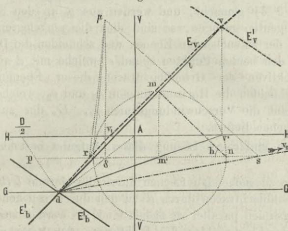
die Grundlinie  $GG$  durch den Durchstosspunkt  $d$  der Geraden  $l$  mit der Bildebene gehe. Es ist sodann  $dv'$  die Perspektive der Grundflächprojektion dieser Geraden.
