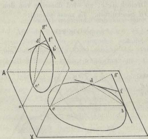
desselben die zwei zu  $AX$  parallelen Tangenten, so wie irgend eine beliebige Tangente  $df$  in  $d$ , und verbindet diesen Punkt  $d$  mit  $b$  und  $c$ , so ist das Dreieck  $bdg$  rechtwinklig, und da  $fb = fd$  ist, muss auch  $fb = fg$  sein.
