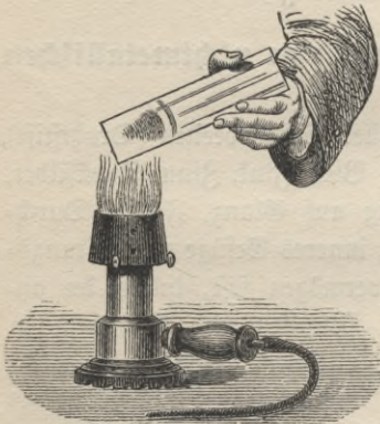
Fig. 1. Anlassen von Eisen.
