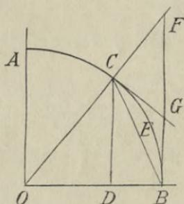
Ist  $ABO$  in Fig. 2 ein Kreisquadrant, so wird  $CD < CB < CEB$  für jeden Punkt  $C$  zwischen  $A$  und  $B$ , dagegen  $CD = CB = CEB$ , wenn  $C$  mit  $B$  zusammenfällt. Daher ist  $\sin a \leq a$  für kleine Winkel  $COB = a$ .
