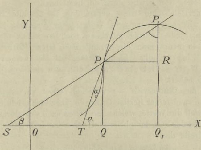
Der Differenzenquotient (1) oder (1<sup>a</sup>) gibt das Steigungsmass der Sekante  $PP_1$  an, welche zu den Kurvenpunkten  $P = (x, y)$  und  $P_1 = (x + \Delta x, y + \Delta y)$  gehört.
