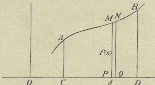
$CD = (b - a)$  in  $n$  gleiche Teile, deren Grösse  $\delta$  sein mag, und errichten in allen Teilpunkten Ordinaten. Dadurch wird die Fläche in  $n$  Streifen zerlegt, wie  $MNQP$ , deren Inhalt bei hinlänglich kleinem  $\delta$  gleich dem Produkte aus  $\delta$  und der zugehörigen Ordinate gesetzt werden kann. Ist also  $y = f(x)$  die Gleichung der Kurve, dann entsteht für die Fläche nach (15), S. 173, der Wert
