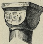
Abb. 71. Einfaches und verziertes Würfelpapitell.
