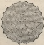
Fig. 13. Durchschnitt des dorischen Säulenschafts.
