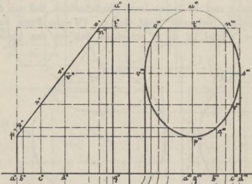
Projektion des Schnittes, die Ellipsen sind, zu erhalten, verwenden wir Hilfsebenen parallel zu  $P_1$ , die den Kugelschnitt treffen. — Diese
