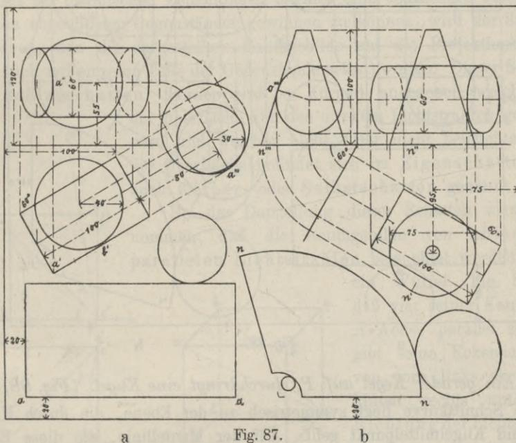
**b)** Ein gerader Zylinder, parallel  $P_1$  und schief zu  $P_2$ , durchdringt einen geraden, auf  $P_1$  stehenden Kegel. (Fig. 87, b.)
