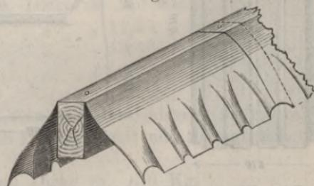
Die Hafter werden von schwedischem Federnstahl angefertigt und verzinkt. Die Nägel werden rauh verzinkt.
