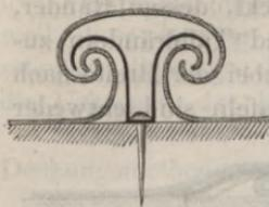
mit einem Deckbleche versehen ist. Diese Falzrücken nehmen die Stelle eines Wellenberges ein, ragen aber etwa um 2 cm. höher über die Dachfläche hinaus. Wendet man statt derselben einfache Löthung an, so müssen an der Unterseite
