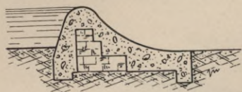
Fig. 78. Wehr aus Beton und Mauerwerk. 1 : 100.
