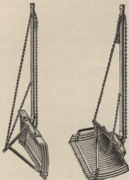
a geöffnet. b geschlossen. Fig. 29. Indische Schaufel.
