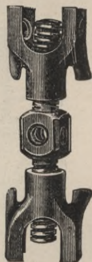
Fig. 111. Schraubenwinde für Druck und Zug.
