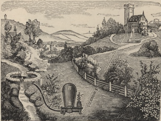
Fig. 50. Anwendung des hydraulischen Widders.
