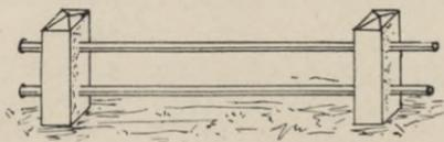
Fig. 134. Geländer mit Steinpfosten.
