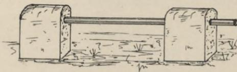
Fig. 133. Geländer mit Betonpfosten.
