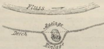
Fig. 607. Wiederherstellung des Deiches nach dem Deichbruch.
