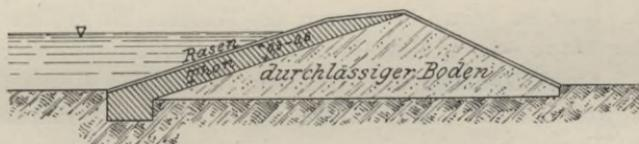
Fig. 605. Dichtung eines Deiches durch Tonböschung.
