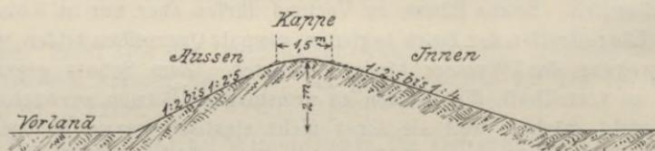
Fig. 603. Querschnitt eines Sommerdeiches von 2 m Höhe.
