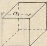
**2. Die Kantensäule oder das Prisma.** Die Kantensäule hat eine Grundfläche und eine mit dieser übereinstimmende Kopffläche. Die übereinstimmenden Ecken der Grund- und Kopfflächen sind mit gleichlaufenden Kanten verbunden.
