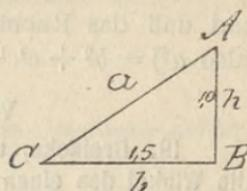
Beträgt nun aber, bei  $h = 1,0$  m, die schräge Böschungsbreite 1,803 m, so erhält man für eine andere Höhe bei demselben Böschungsverhältnis die Böschungsbreite, wenn man diese Höhe mit 1,803 multipliziert; z. B. ist für eine Höhe = 2,23 m alsdann die Böschungsbreite  $a = 2,23 \cdot 1,803 = 4,02$  m.
