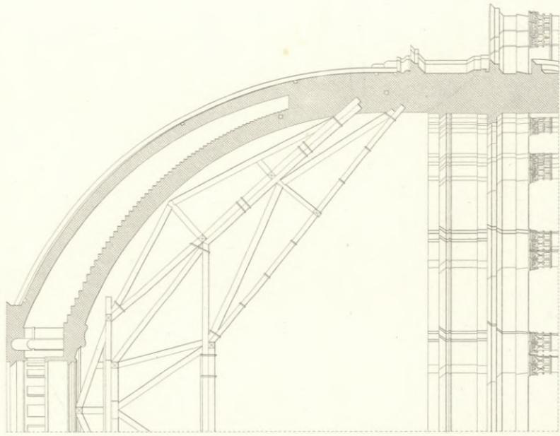
Elevation d'une ferme de la charpente de la grande Coupole.
