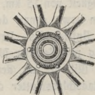
Antrieb Zahnkranz an Radnabe angeschraubt („Nacke“-Wagen)
