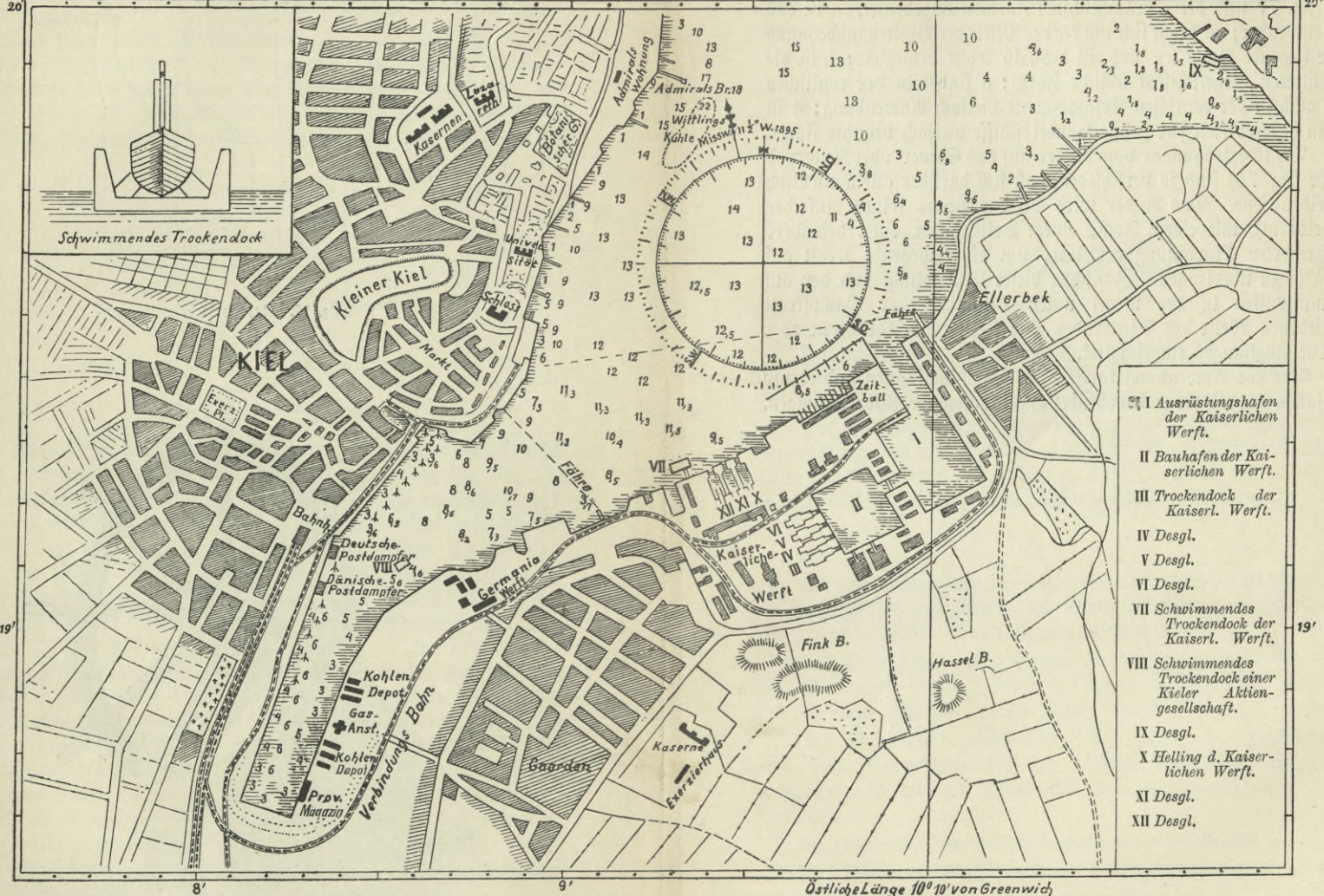
Fig. 73. Innerer Teil des Reichskriegshafens von Kiel mit den Werft- und Dockanlagen nebst Darstellung eines schwimmenden Trockendocks. (Siehe S. 98.)
