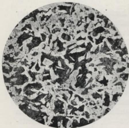
Fig. 48\*. Flußeisen mit 0,7 % Kohlenstoffgehalt.  $V = 135$ .
