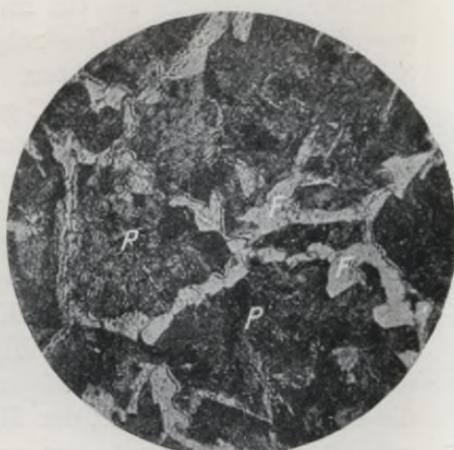
Fig. 53.\* Stahlguß mit 0,4 % Kohlenstoffgehalt.  $V = 250$ .
