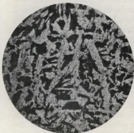
Fig. 95\*. Eisenbahnradreifen, normales Gefüge.  $V = 94$ .
