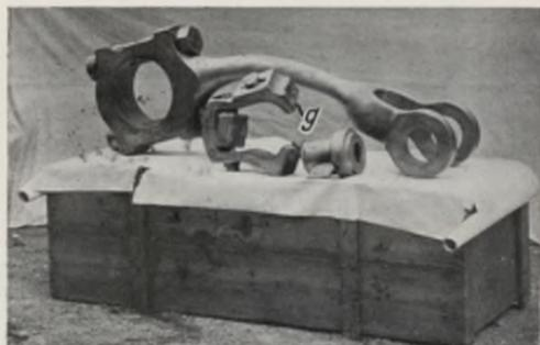
Fig. 107. Durch dauernd wechselnde Beanspruchung gebrochener Kreuzkopf nebst Kurbelstange.
