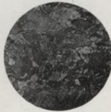
Fig. 111\*. Derselbe Kupferdraht wie Fig. 110, jedoch gegläht.  $V = 100$ .
