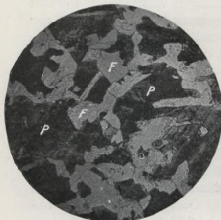
Fig. 52\*. Stahlguß mit 0,3 % Kohlenstoffgehalt.  $V = 250$ .
