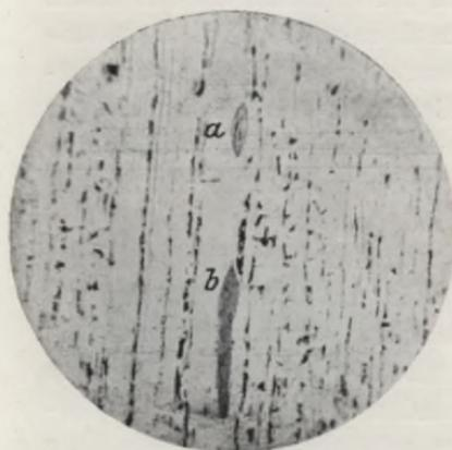
Fig. 98. Sulfideinschlüsse in kohlenstoffarmem Flußeisen. V = 68.
