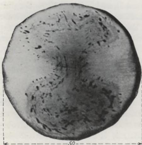
Fig. 34. Flußeisenrundstab mit 8 förmiger Seigerung.
