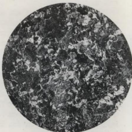
Fig. 49\*. Flußeisen mit 0,5 % Kohlenstoffgehalt.  $V = 135$ .
