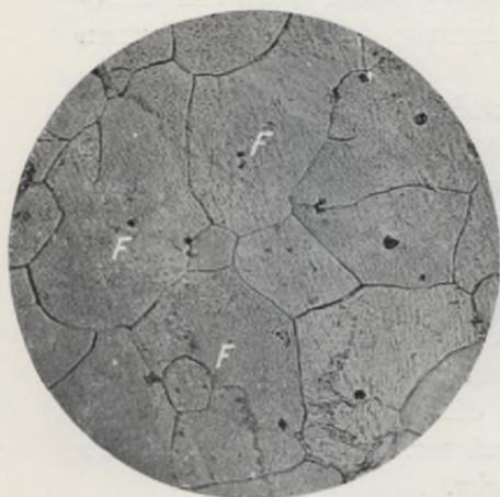
Fig. 50\*. Stahlguß mit 0,07 % Kohlenstoffgehalt.  $V = 250$ .
