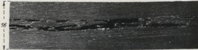
Fig. 8. „Doppeltes“ Flußeisenblech.
