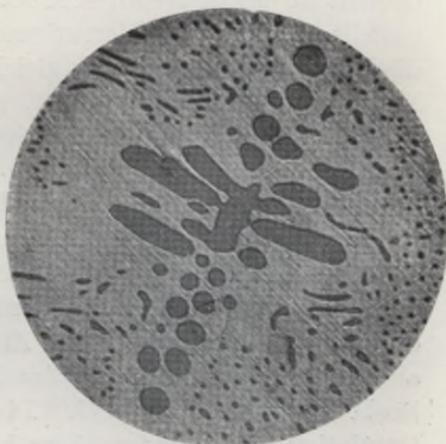
Fig. 115. Kupfer mit Kupferoxydulschlüssen.  $V = 100$ .
