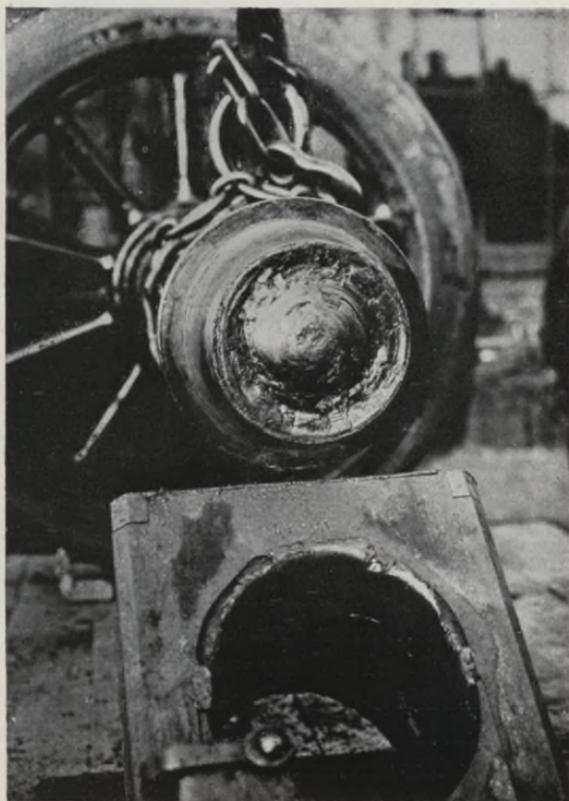
Fig. 109\*. Durch Warmlauf gebrochene Lokomotivachse.
