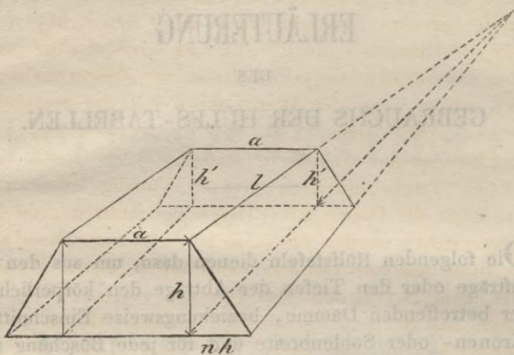
Wird nun zur Vereinfachung des Ausdrucks und Erlangung von Verhältniszahlen für die Einheiten die Länge des Körpers  $l$  gleich Einer Ruthe von 12 Fuss, die Kronenbreite  $a$  gleich Einen Fuss, die Böschung einfüssig, also  $n$  gleich Eins angenommen, so ergiebt sich der körperliche Inhalt in Schachtrüthen zu 144 Kubikfuss:
