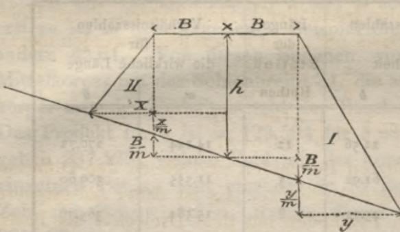
Wird nach nebenstehender Figur die obere Damm- oder untere Einschnittsbreite mit  $2B$ , die Höhe (beziehungsweise Tiefe) in der Mittellinie mit  $h$  bezeichnet, die Damm- oder Einschnittsböschung  $n$ füssig angenommen, so ergibt sich der Flächen-Inhalt des mittleren trapezförmigen Theiles des Quereinschnitts zu
