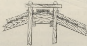
Abb. 61. Deckstützen-Konstruktion auf Elbekähnen.
