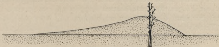
Abb. 225. Sandanhäuerung bei einer festen durchlässigen Wand.
