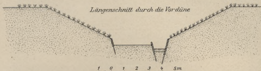
Abb. 305. Führung eines Fahrweges und eines Grabens durch die Vordüne.
