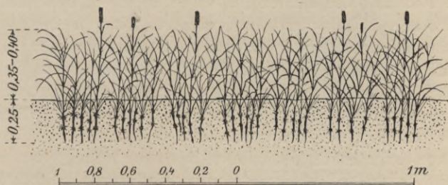
Abb. 243. Bildung der Sandgrasreihen aus flachen Büscheln.
