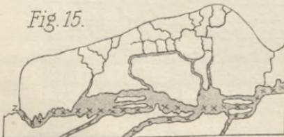
et, etwas vereinfacht) stellt neben der Quelle ( $z$ ) den südlichen Teil des Bodenwassers in einem nach unten erweiterten und nur zum Teil gefüllten Spaltensysteme dar.
