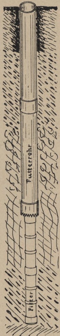
Abbildung 36. Brunnen nach Entfernung der Mantelrohre mit eingezogenem Filter.
