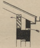
Lüftungseinrichtung. — 1/50 n. Gr.
