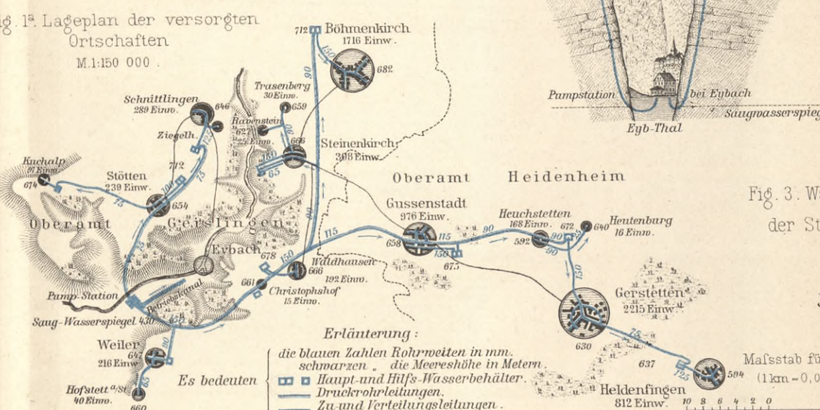
Fig. 1 a u. 1 b Wasserversorgung der rauhen Alb. Gruppe I. Längen 1:60 000, Höhen 1:6000.
