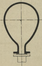
Windkessel für Hydranten.
