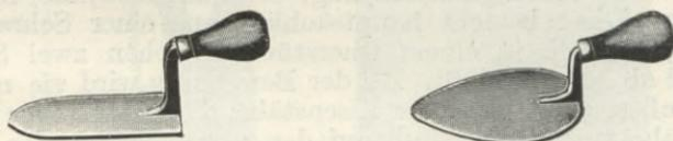
Abb. 30 und 31. Kellen zum Einfüllen des Mischgutes.
