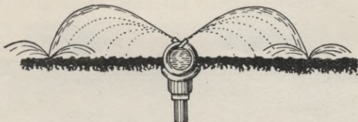
Fig. 125. Giers & Harrisons fest montierter Zerstäuber in Tätigkeit.
