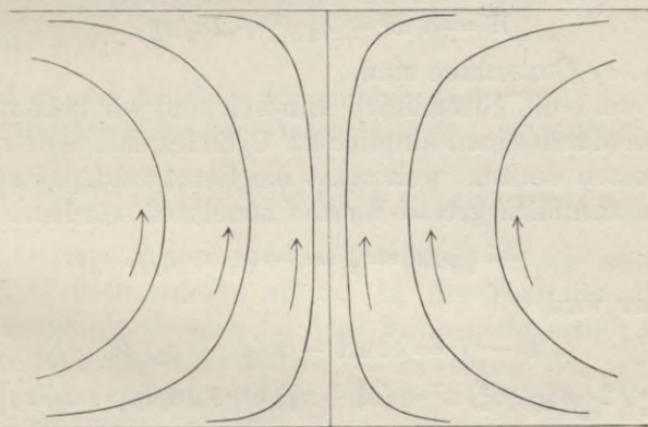
Fig. 4. Stromlinien einer Cyklone mit horizontaler Ausströmung.
