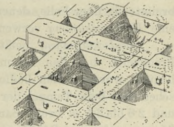
Quaderrost. Apollontempel zu Delphi. (Durm, Die Baukunst der Griechen.)
