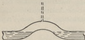
Abb. 97. Luftsack in einer Rohrleitung.
