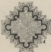
Fig. 99. Pfeilerquerschnitt (Dom zu Naumburg).
