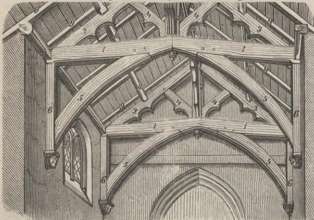
Fig. 353. Dachstuhl (Häng- u. Sprengwerk) aus Abderbury (Oxfordsh.), 14. Jahrh.
